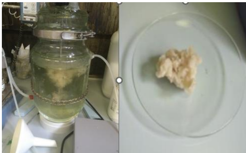
Figura 3.2.2.2 Formazione materiale colloso durante l'aggiustamento soluzione a pH 2.5
