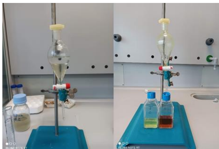
Figura 3.5.1 Estrazione indio mediante D2EPHA in imbuto separatore
