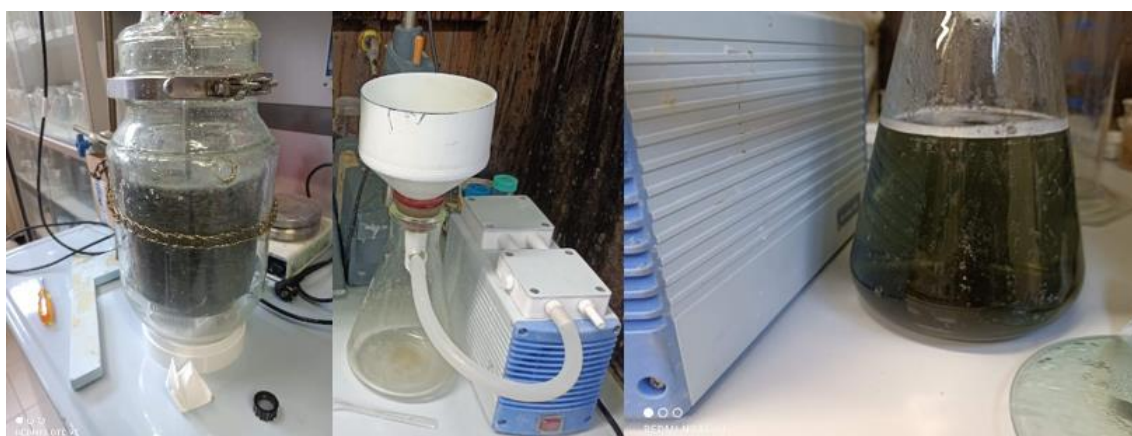
Figura 3.2.1.1 Processo di lisciviazione acida
