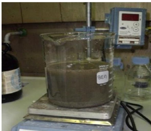
Figura 3.3.1 Lavaggio LCD (20% m/v, 30 min, agitazione magnetica)
