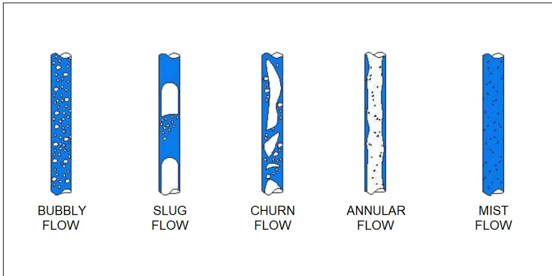
Fig. 1.5: Regimi di flusso gas-liquido in tubi verticali
