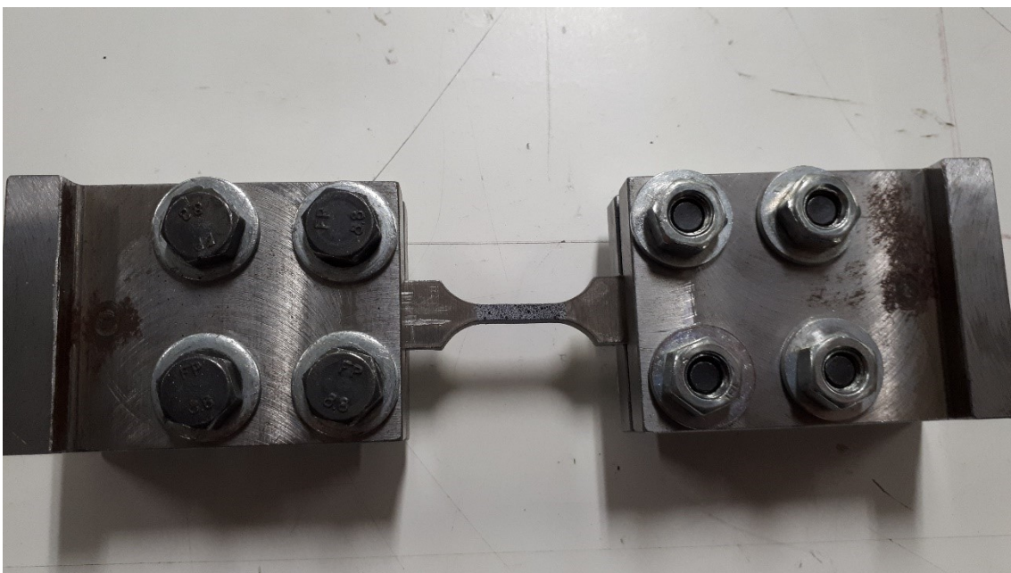
Fig. 4.1 Provino bloccato per attrito all'interno degli afferraggi tramite il serraggio degli otto bulloni.
