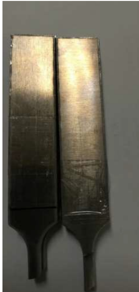
Fig. 2.12 Particolare di due provini uno trasversale [destra] e l'altro longitudinale [sinistra], utilizzati per prove di fatica.
