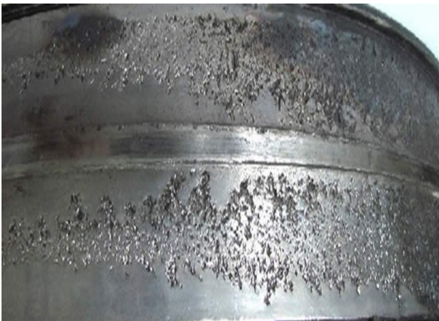
Fig. 1.7 danneggiamento superficiale da fatica da contatto sulla superficie interna di un cuscinetto a rulli, causata da pressioni di contatto eccessive.
