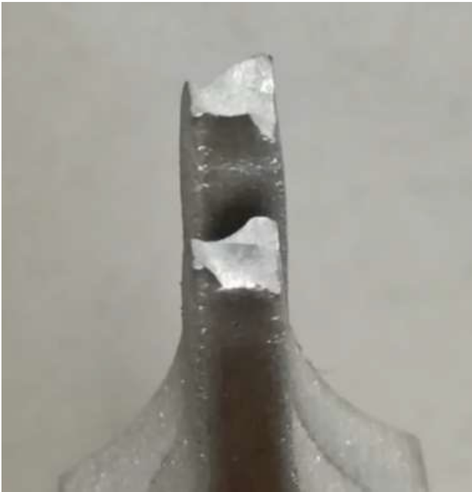
Fig. 2.22 Particolare di frattura di un provino in alluminio 5754 H22 a seguito di una prova di trazione.
