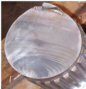
Fig. 1.14 esempio di rottura a fatica di un albero di trasmissione sottoposto a tensioni nominali di lieve entità.
