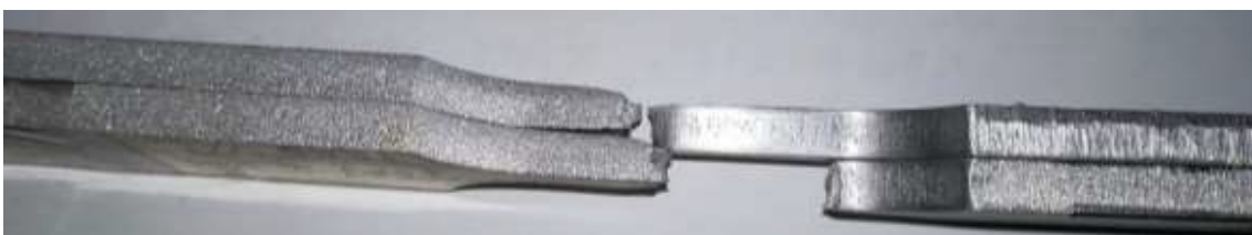
Fig. 2.17 Particolare del tratto utile di due provini, uno non lucidato, usato per la prova di trazione (sinistra) e uno lucidato, rotto per fatica (destra).
