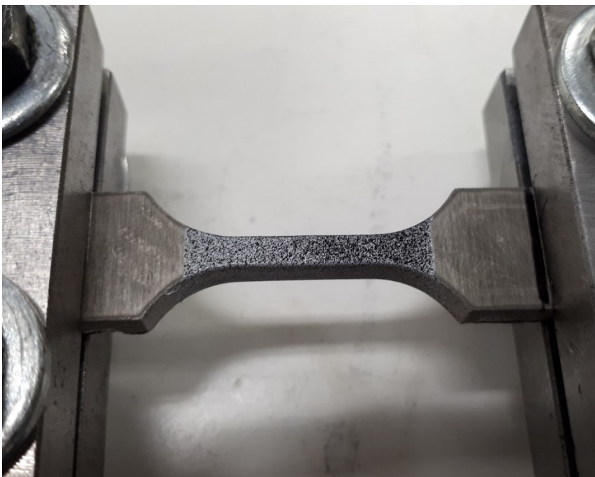
Fig. 4.2 Tratto utile del provino caratterizzato da verniciatura "speckle".
