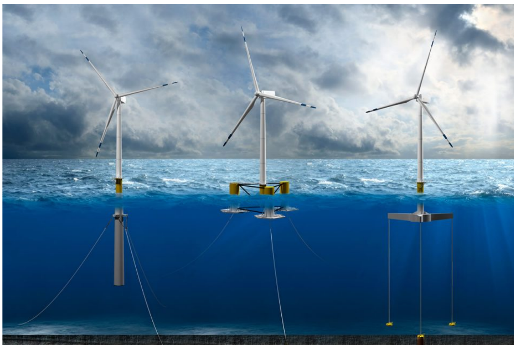
Figura 1.3: Tipologie di ancoraggi per turbine eoliche flottanti in acque profonde
