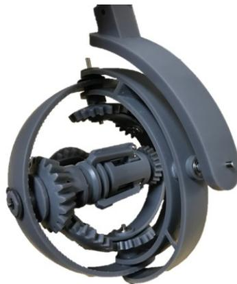
*Figura 4.7 Giunto riconfigurabile.*
