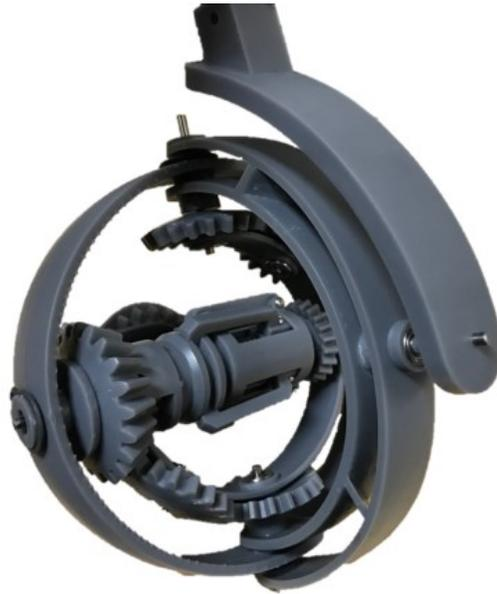
*Figura 5.1 Rendering del giunto riconfigurabile.*
