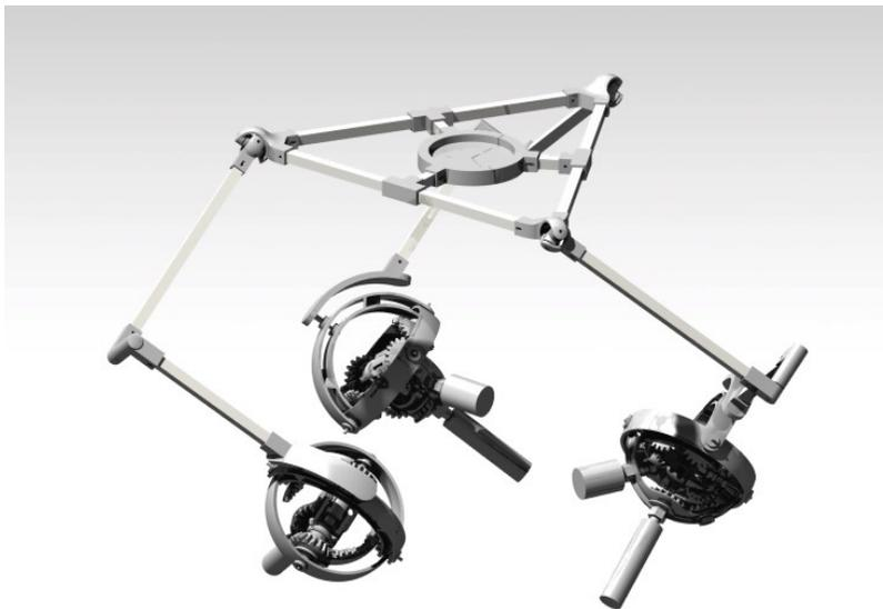
*Figura 1.2 Prototipo manipolatore riconfigurabile 3-URU.*
