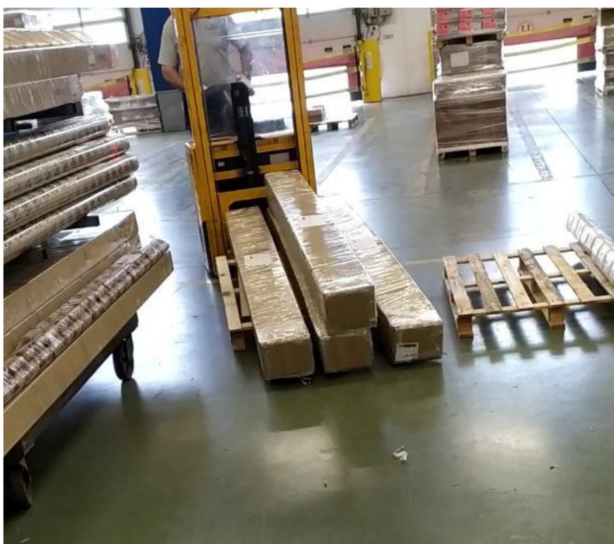
Figura 4 - 56: Prelievo prodotti con pallet non idonei
