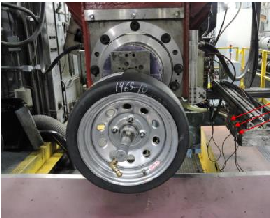
Figura 3.1: banco prova per test pneumatici
