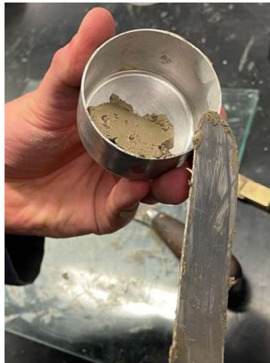
Figura 29- (a) Prelevamento del materiale dal centro del cucchiaio di Casagrande; (b) Materiale inserito in una coppetta.
