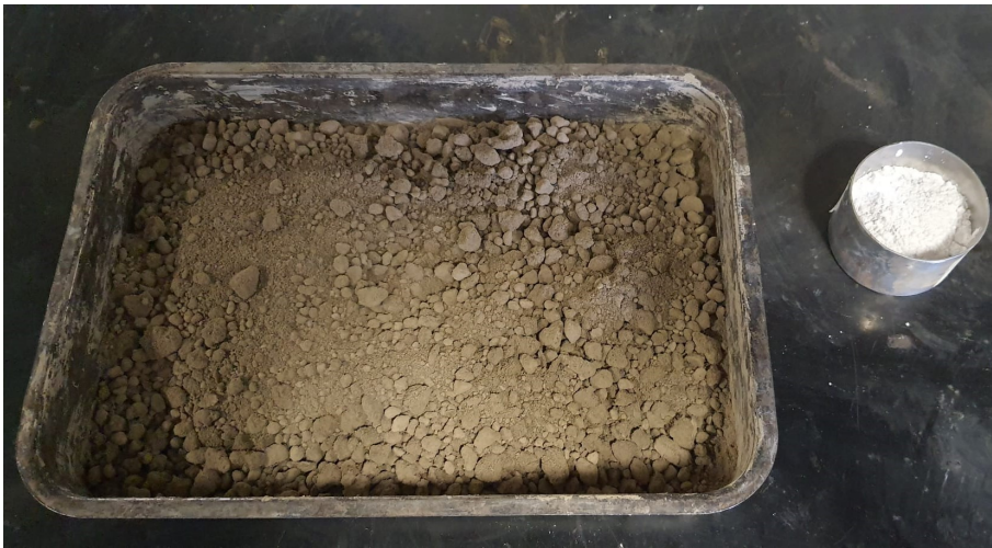
Figura 23- Teglia con sedimento umidificato e coppetta con calce.
