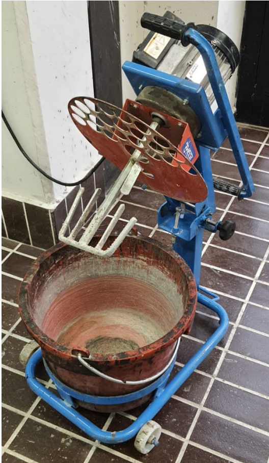
Figura 32- Planetaria utilizzata nella creazione delle varie miscele.
