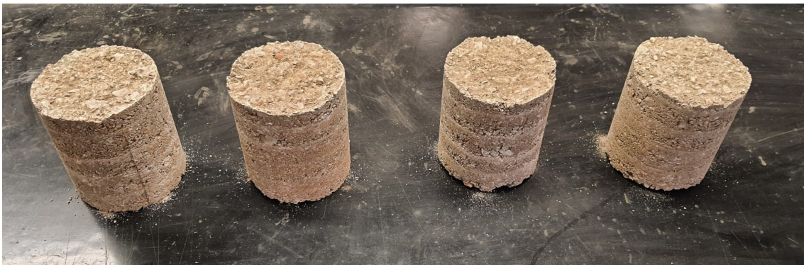
Figura 60- Provini pronti per essere sottoposti alla prova di trazione indiretta.
