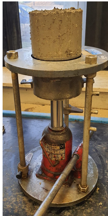
Figura 37- Estrusore usato per estrarre il provino.
