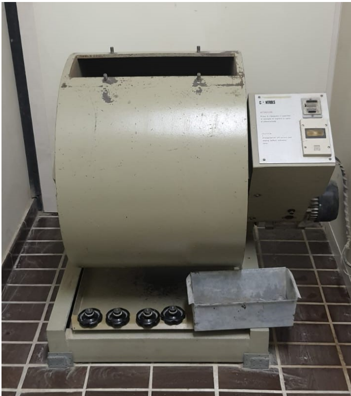
Figura 9- Macchinario Los Angeles per frantumazione sedimento.
