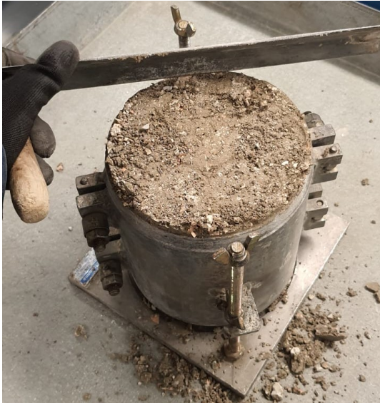
Figura 35- Livellamento della superficie della fustella.
