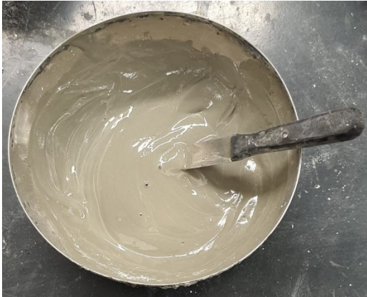
Figura 51- Boiaccia di cemento da applicare sulla superficie dei provini.
