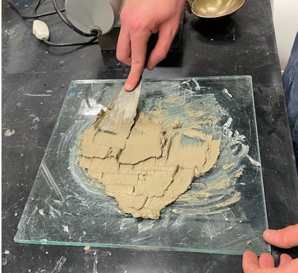
Figura 26- Mescolamento di sedimento con spatola su lastra di vetro.
