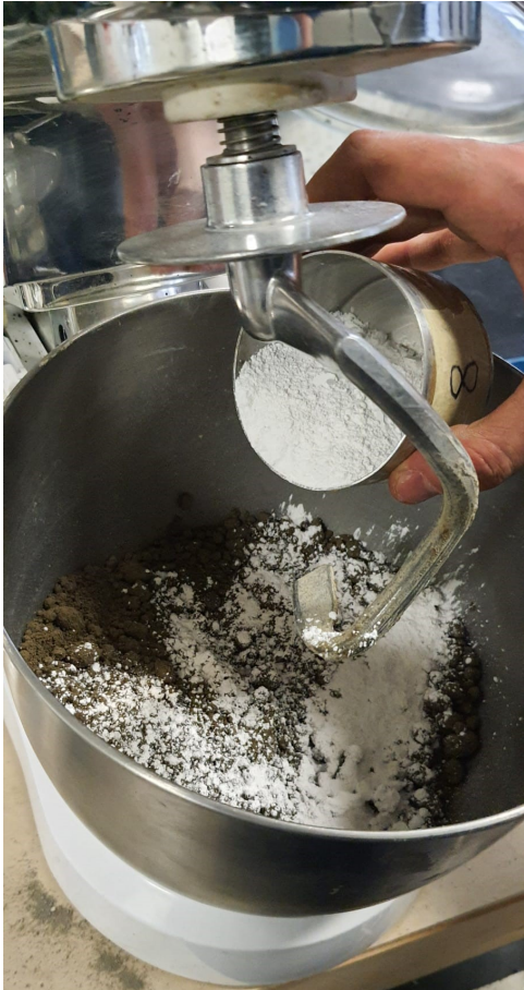
Figura 24- Aggiunta di calce al sedimento umidificato.
