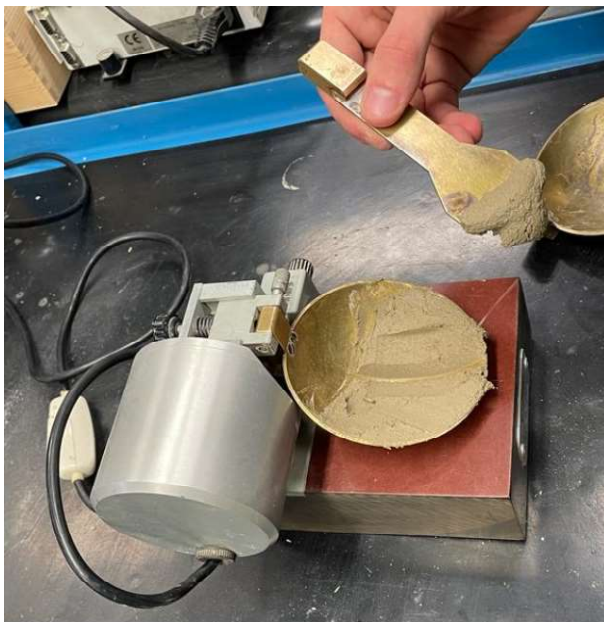
Figura 27- Utilizzo della spatola standardizzata per creare il solco nel cucchiaino di Casagrande
