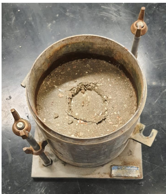
Figura 49- Provino con impronta del pistone di prova.
