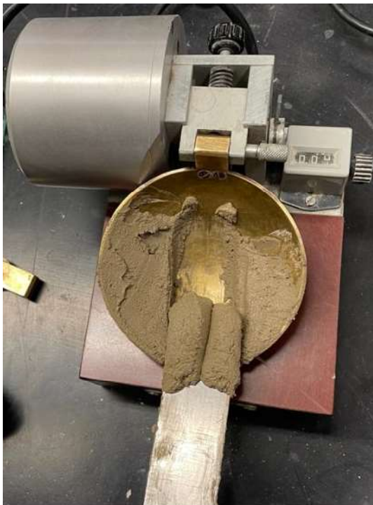
Figura 29- (a) Prelevamento del materiale dal centro del cucchiaio di Casagrande; (b) Materiale inserito in una coppetta.
