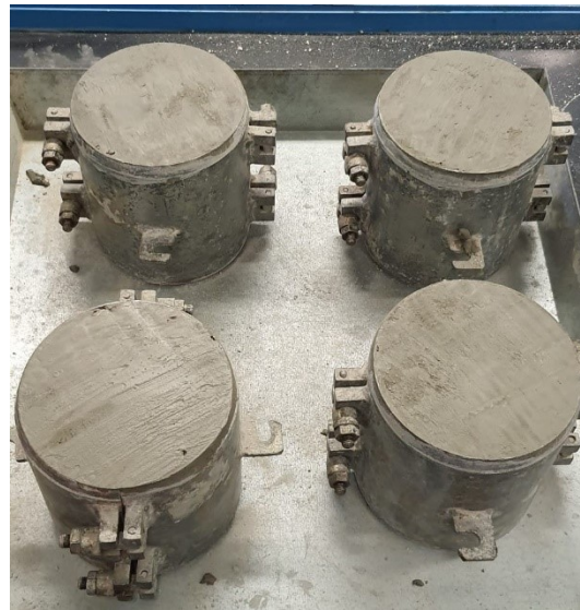
Figura 53- Provini dopo l'applicazione della boiaccia.
