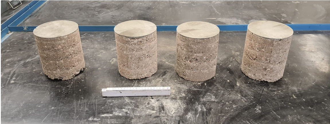
Figura 54- Quattro provini pronti ad essere sottoposti alla prova di compressione.
