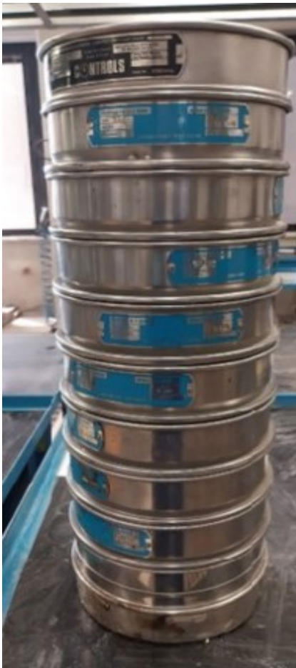
Figura 20- Esempio pila di setacci di laboratorio. Figura 21- Vibrovaglio con pila di setacci applicata.
