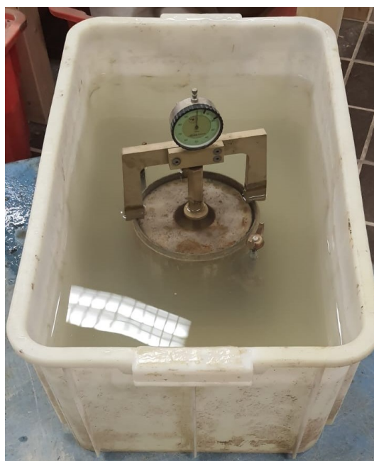
Figura 47- Provino con comparatore immerso in vasca.
