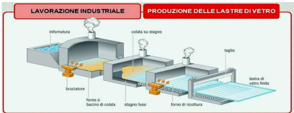
Figura 1.1 produzione delle lastre di vetro (3)
