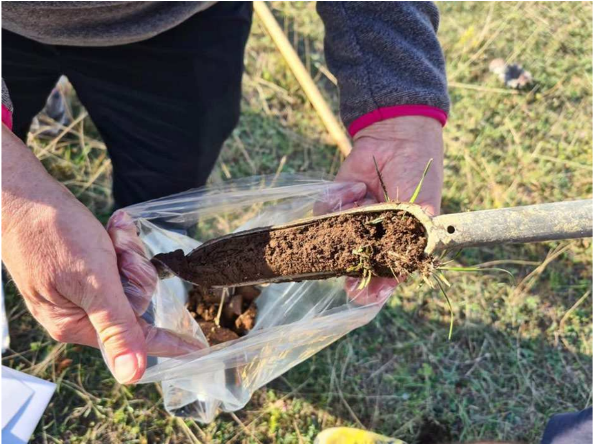
Figura 4-9 Foto di campionamento di suolo con trivella condotto su suoli terrazzati del Parco della Majella
