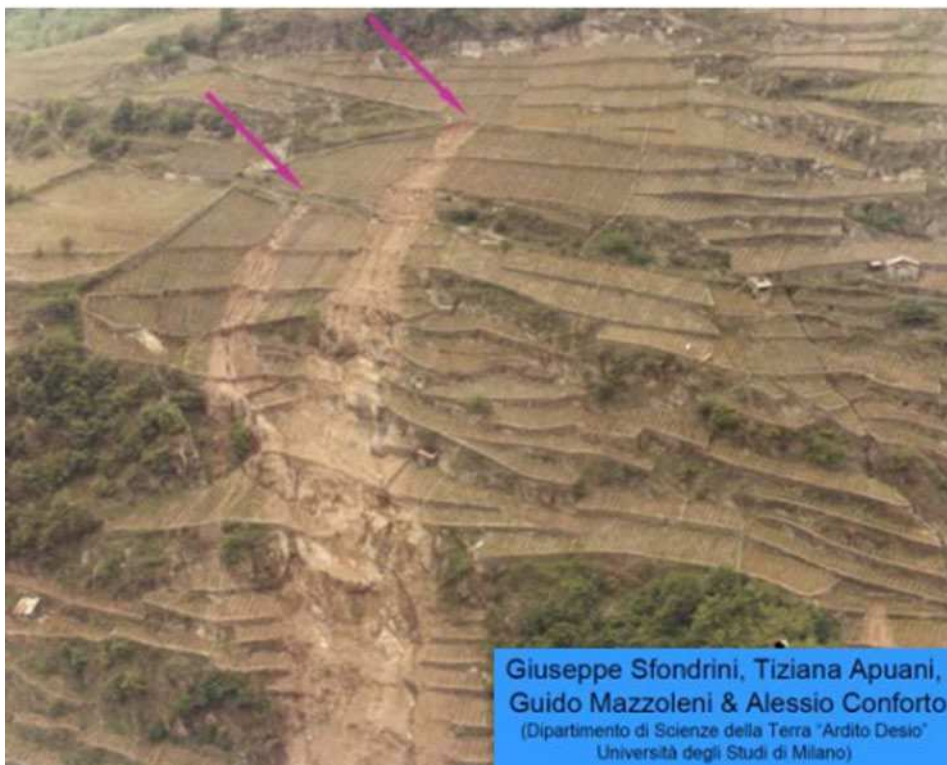
Figura 4-6 Il dissesto dei terrazzi può innescare movimenti franosi con un meccanismo "a domino"
