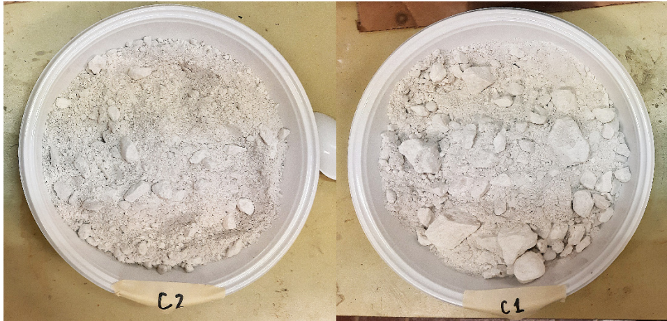
Fig. 24 Confronto aggregati utilizzati nei campioni C2 (sinistra) e C1 (destra)
