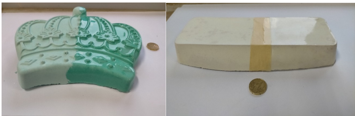
Fig. 66 Applicazione GELCOAT: provino corrugato con colorante GETTO 2 (a sinistra), provino parallelepipedo senza colorante GETTO 2 (a destra)
