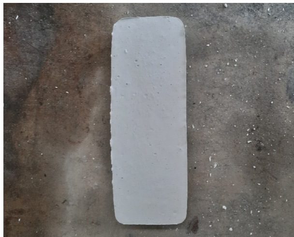
Fig. 106 Presenza di bolle sulla superficie a contatto con l'ambiente, provino da cassero in silicone
