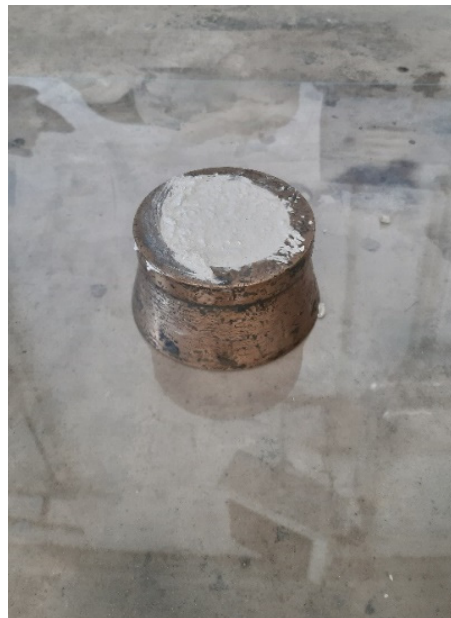
Fig. 51 Preparazione prova di lavorabilità
