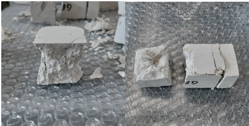
Fig. 73 Superficie di rottura prova di compressione getto 1 (a sinistra) e getto 2 (a destra)
