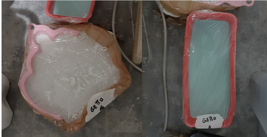
Fig. 53 Preparazione casseri per la stagionatura in camera climatica
