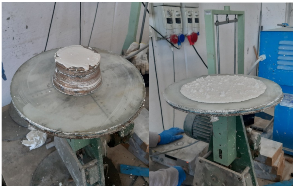
Fig. 85 Preparazione tronco di cono per slump flow test (a sinistra), slump flow test tramite 15 colpi (a destra)
