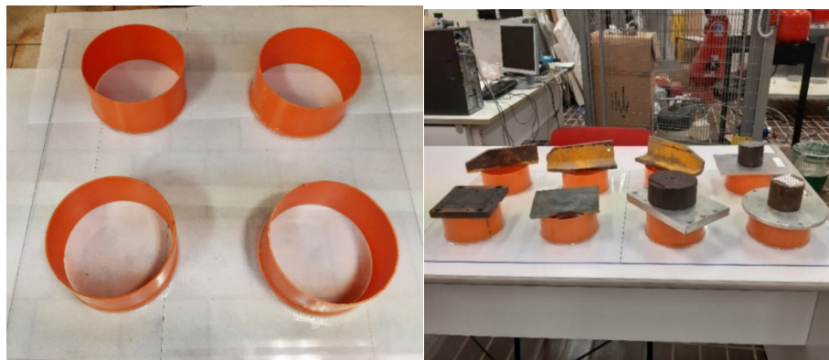
Fig. 23 Preparazione Casseri in PVC
