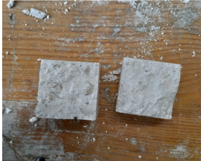
Fig. 105 Superficie di rottura a flessione, getto 2 C+R
