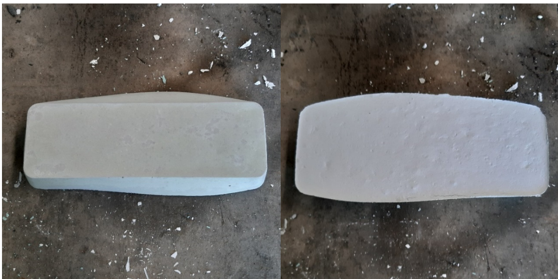
Fig. 64 Provino parallelepipedo senza colorante: superficie a contatto con il cassero in silicone (a sinistra) e superficie a contatto con l'ambiente (a destra)
