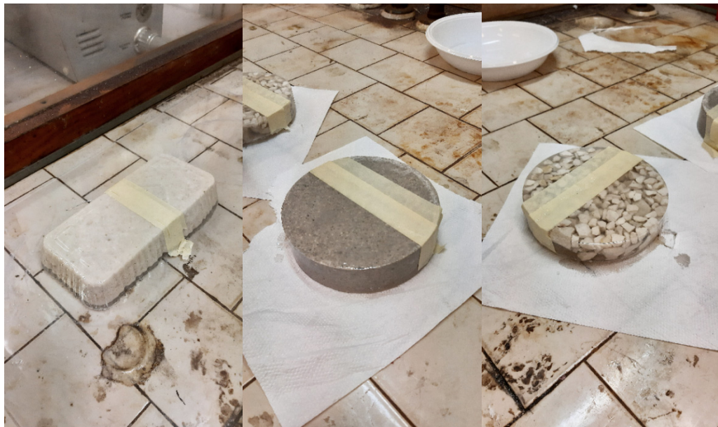
Fig. 41 Applicazione Gelcoat sui campioni C4.1 (a sinistra), C2 (al centro) e C3.2 (a destra)
