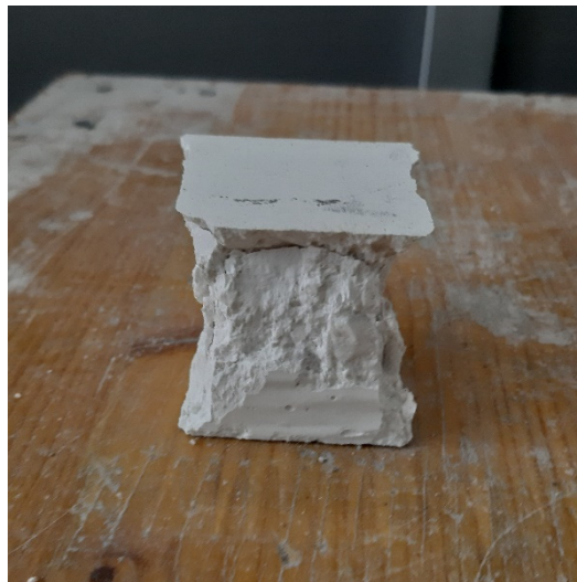
Fig. 111 Superficie di rottura a compressione
