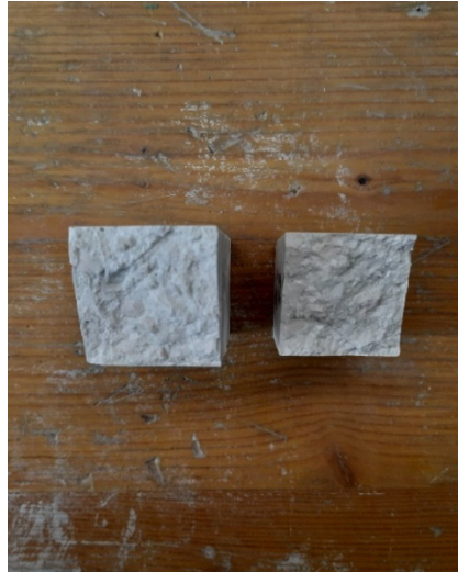
Fig. 100 Superficie di rottura a flessione, getto 2 C
