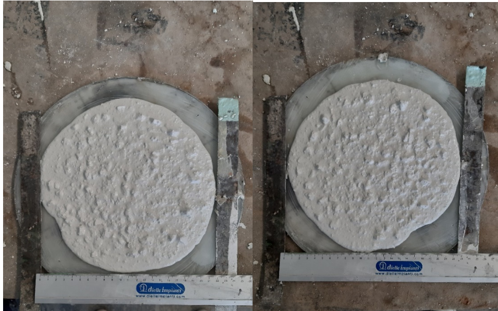
Fig. 86 Slump d1 (a sinistra), slump d2 (a destra)
