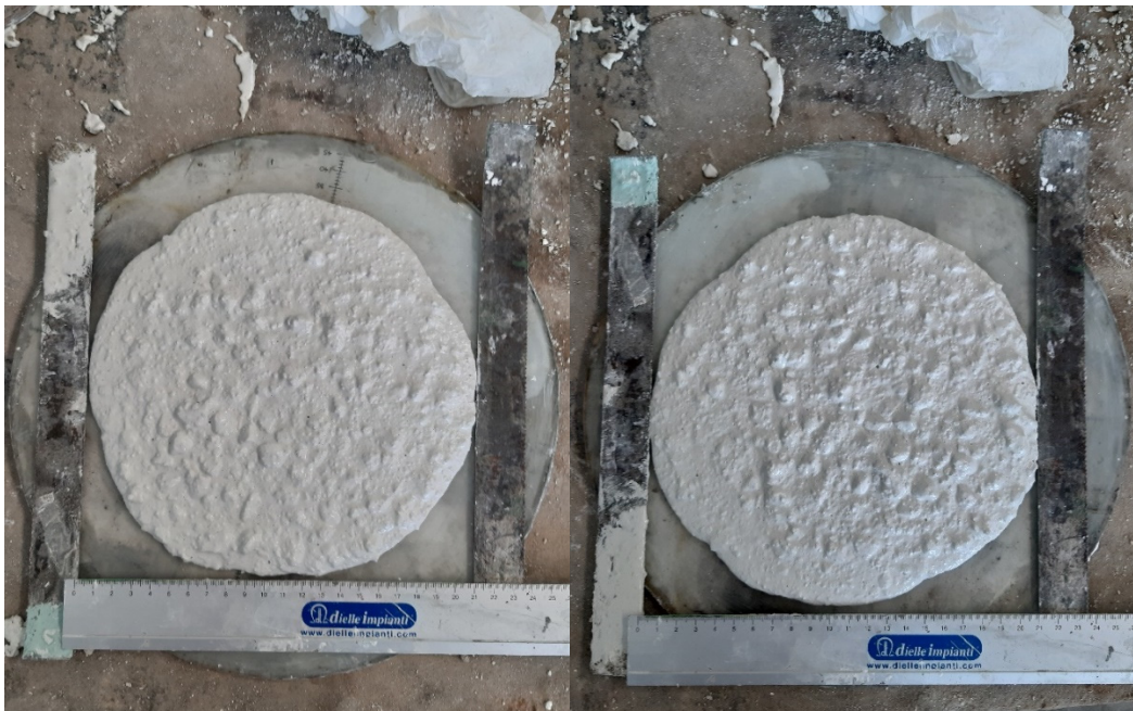
Fig. 90 Slump d1 (a sinistra), slump d2 (a destra)
