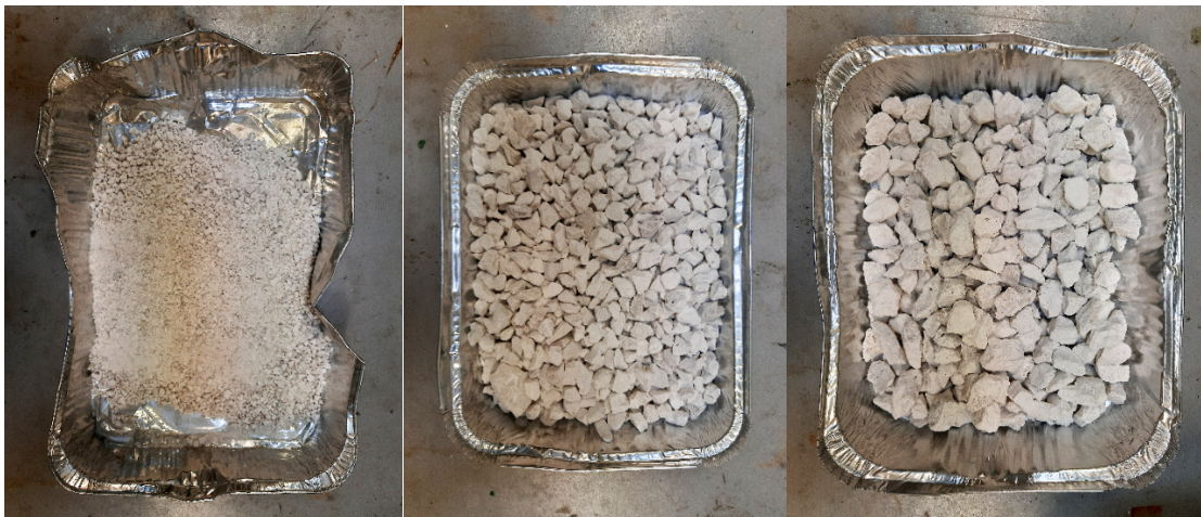
Fig. 50 Inerti utilizzati (Sabbia 0-6, Graniglia 6-12, Graniglia 12-20) - Gola della Rossa mineraria (Scala metrica: Foto 1, L = 20 cm. Foto 2, L = 17,5 cm. Foto 3, L = 25 cm)
