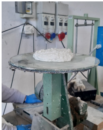
Fig. 83 Esecuzione slump flow test tramite 15 colpi
