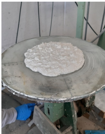
Fig. 88 Esecuzione slump flow test tramite 15 colpi
