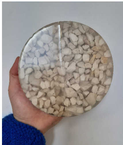
Fig. 42 Risultato sul campione C3.2 (parte sinistra con Gelcoat, destra senza)
