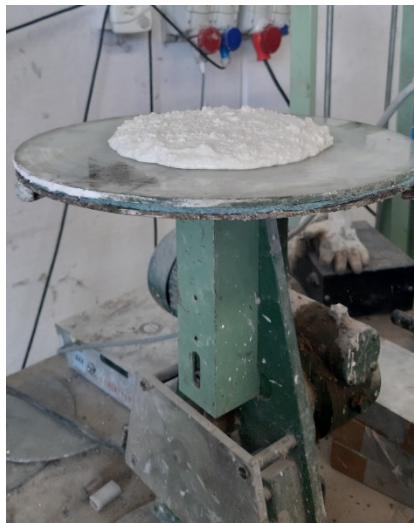
Fig. 80 Esecuzione prova slump flow test per le malte tramite 15 colpi
