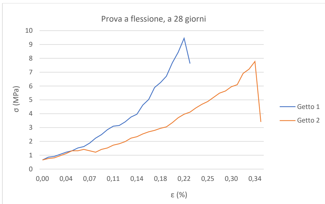
Fig. 75 Grafico TENSIONE - ABBASSAMENTO getto 1 e getto 2
