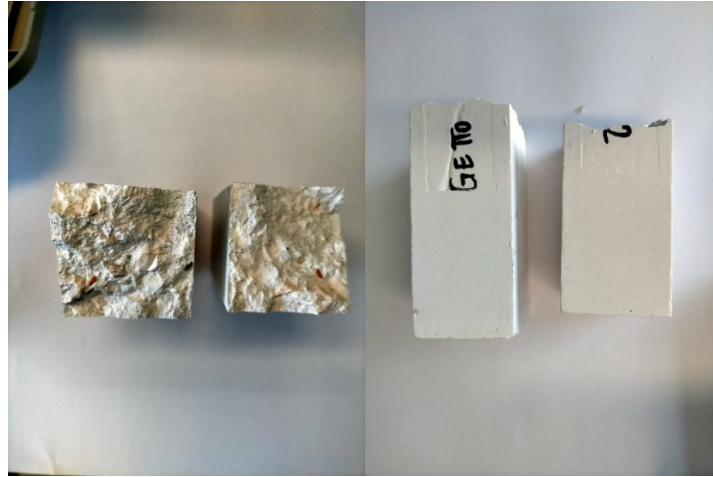
Fig. 76 Superficie di rottura provino getto 1 (a sinistra) e getto 2 (a destra)
