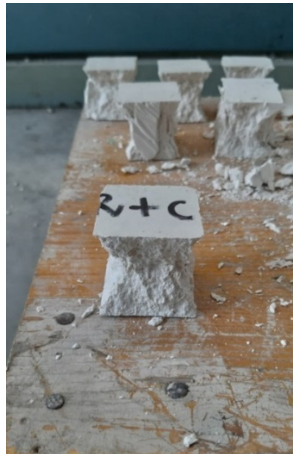
Fig. 103 Superficie di rottura a compressione
