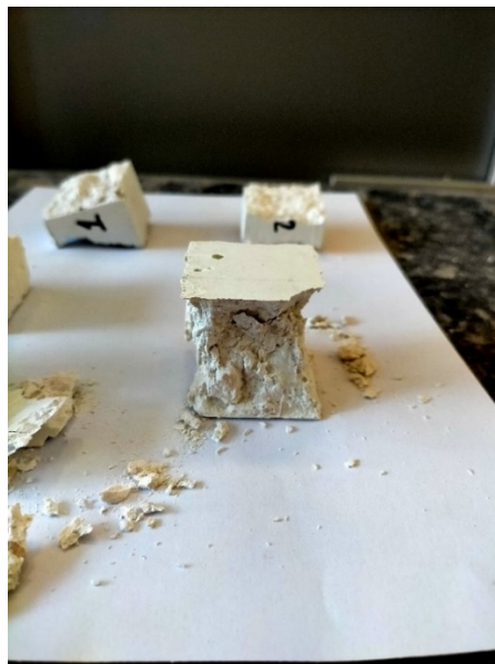
Fig. 79 Superficie di rottura a compressione
