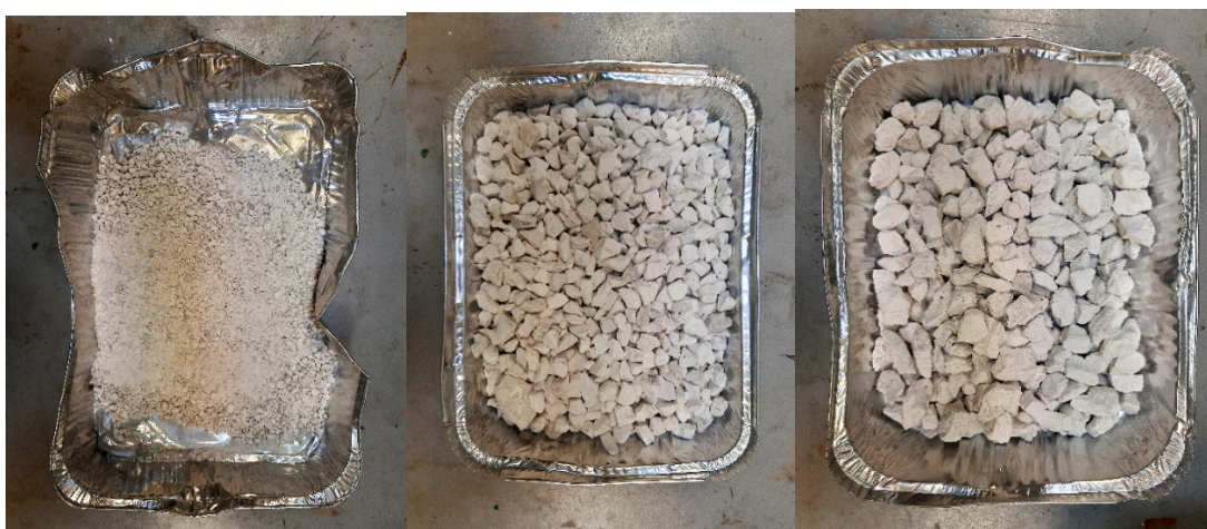
Fig. 12 Inerti utilizzati (Sabbia 0-6, Graniglia 6-12, Graniglia 12-20) – Gola della Rossa mineraria (Scala metrica: Foto 1, L = 20 cm. Foto 2, L = 17,5 cm. Foto 3, L = 25 cm)
