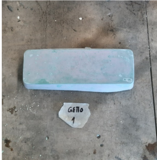
Fig. 61 Provino parallelepipedo con colorante: superficie a contatto con il cassero in silicone
