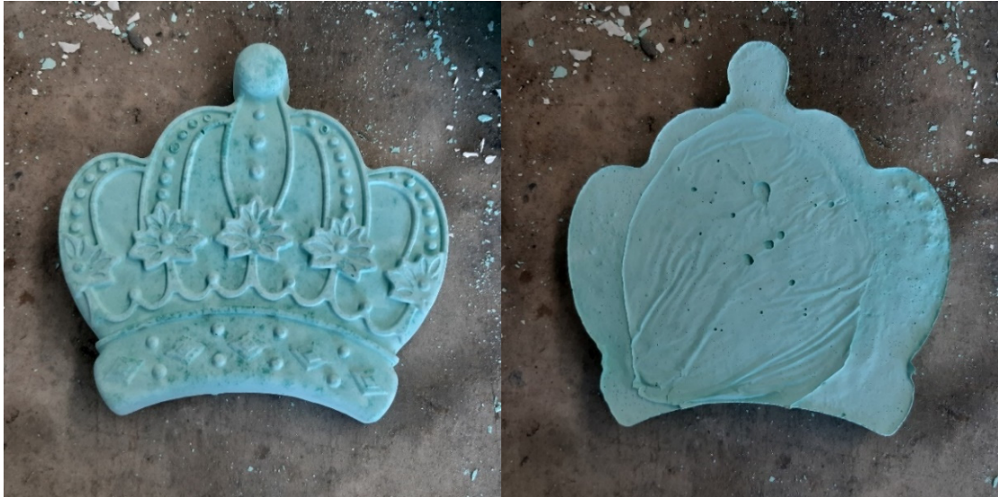
Fig. 63 Provino corrugato con colorante: superficie a contatto con il cassero in silicone (a sinistra) e superficie a contatto con l'ambiente (a destra)
