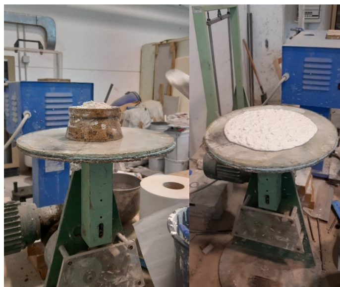
Fig. 56 Prova slump flow test per le malte tramite tavola a scosse
