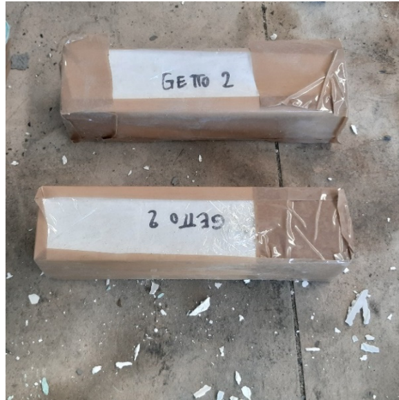
Fig. 65 Esempio di provino ricoperto nuovamente con pellicola trasparente
