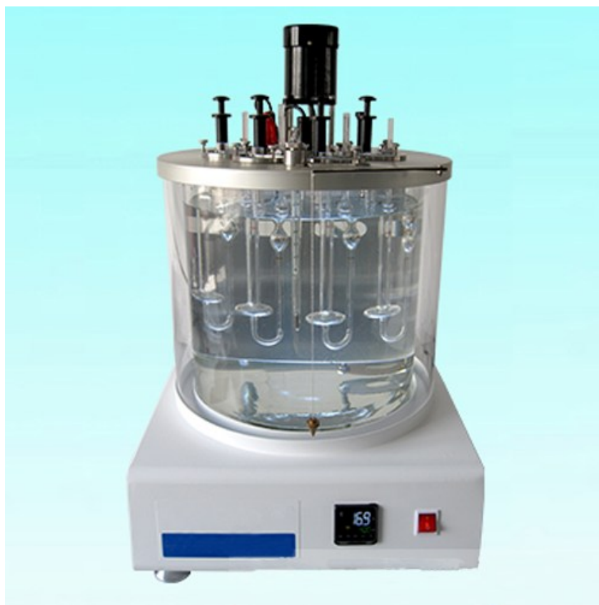
Figura 29: Viscosimetro per il calcolo della viscosità cinematica
