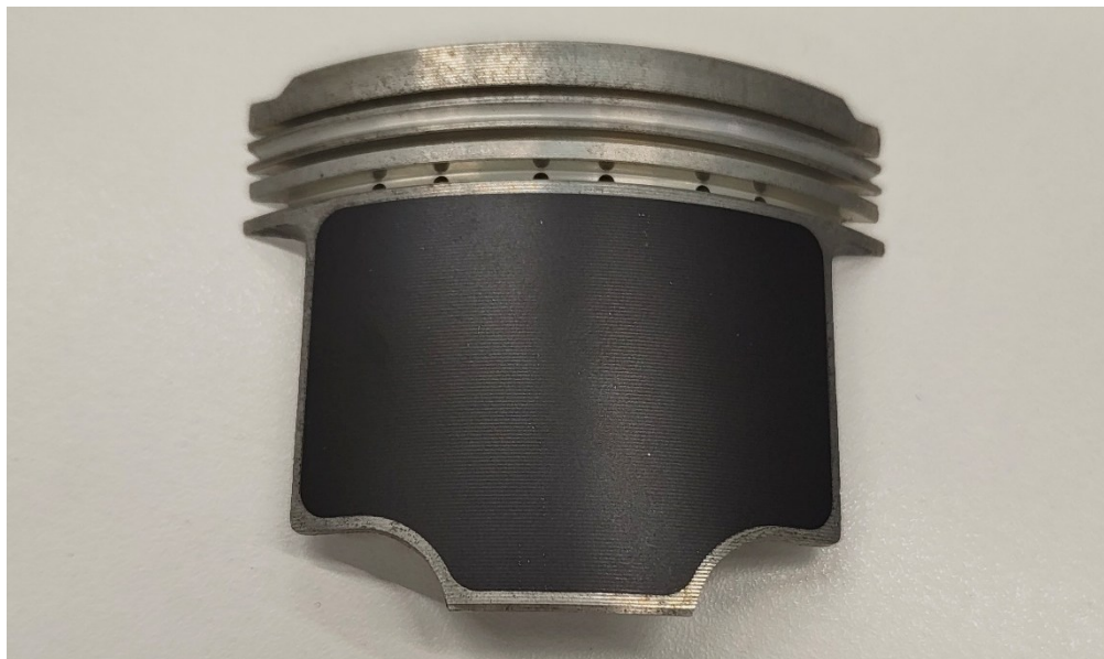
Figura 13: Mantello del pistone del Honda Africa Twin
