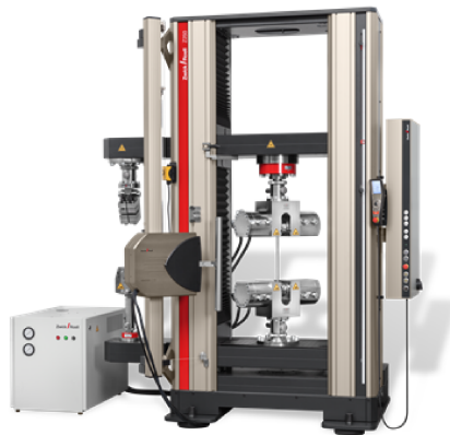
Figura 1.18.: Macchina modulare per prove multiassiali.
