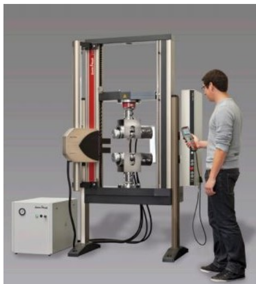
Figura 2.1.: Macchina Allround Line da 30 a 100 kN.
