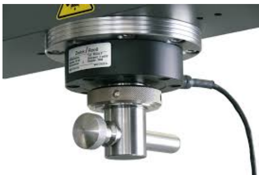
Figura 2.3.: Cella di carico Xforce.
