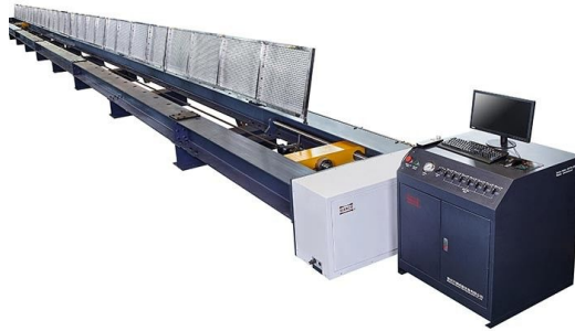
Figura 1.13.: Macchina di trazione orizzontale.
