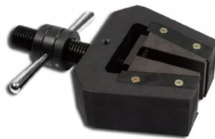
Figura 3.1.: Un' esempio di sistema di afferraggio che utilizza morsetti a forma di cuneo
