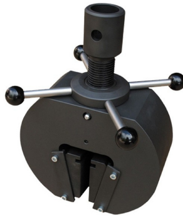
Figura 1.20.: Afferraggio meccanico a cuneo.
