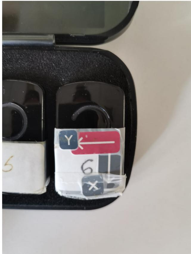
Figura 2.2: Particolare di una sonda IMU con in evidenza il relativo sistema di riferimento
