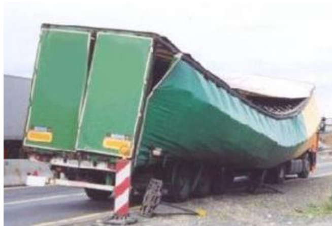
Figura 5: mancato fissaggio laterale e resistenza parete di appoggio inadeguata.
