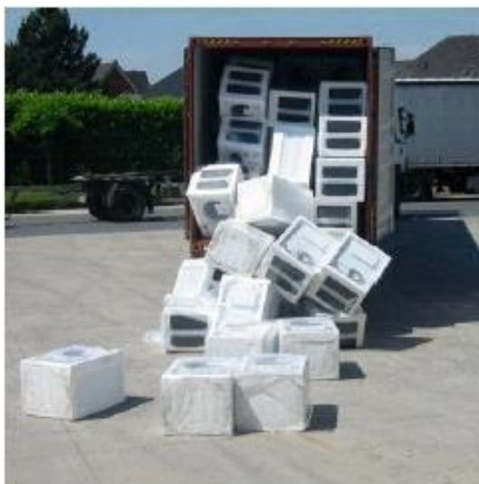
Figura 6: mancato imballaggio di pacchi con conseguente ribaltamento.
