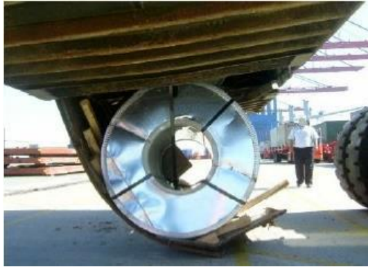
Figura 7: Pavimento UTI sovraccaricato
