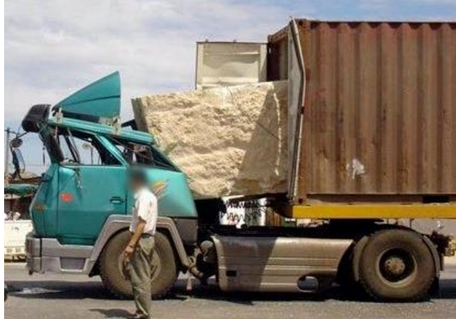
Figura 4: mancato fissaggio longitudinale.
