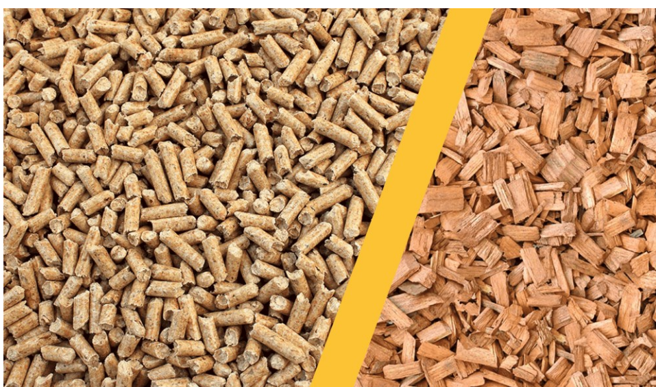
Figura 4-3: Il pellet (a sinistra) ed il cippato (a destra); entrambe le tipologie di biomassa ligno-cellulosica possono essere utilizzate sia in stufa che in caldaia, al fine di produrre energia termica.
