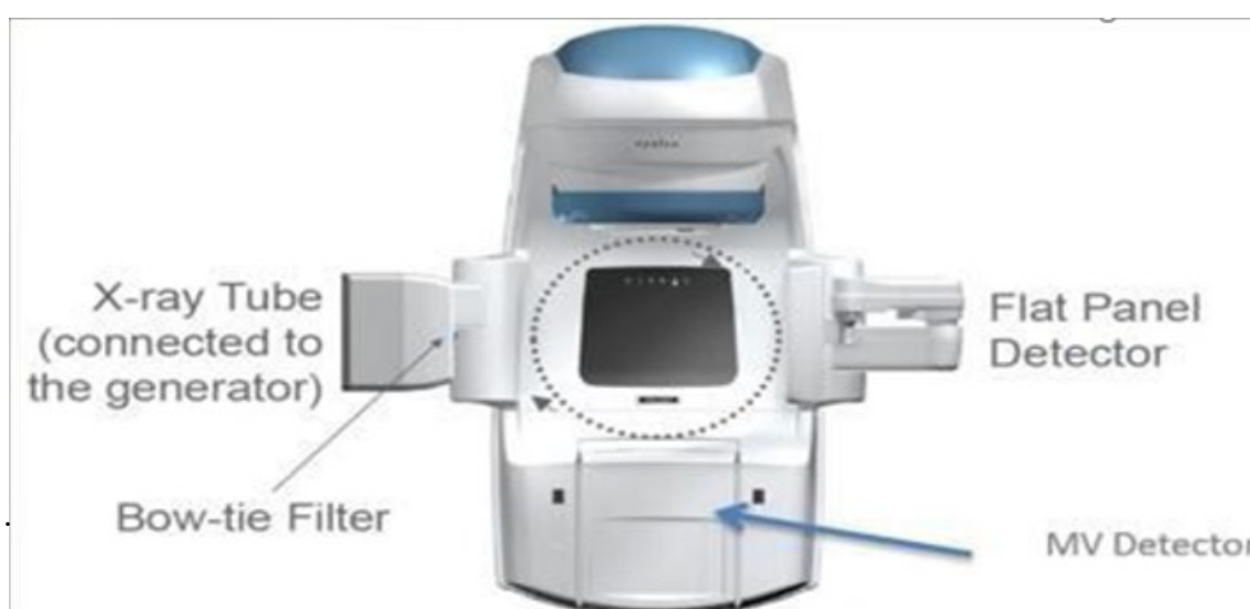
Figura 10: COMPONENTI PER L'IGRT NEGLI ACCELERATORI LINEARI
