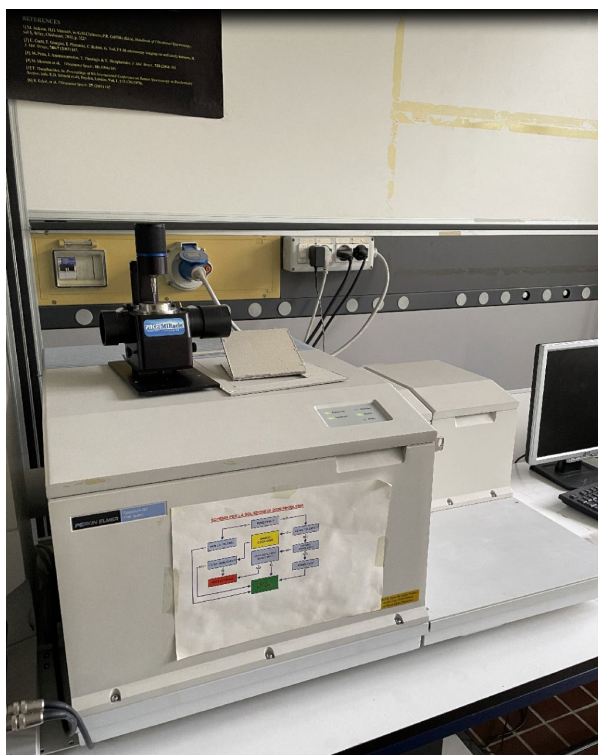
Figura 2.58: Strumentazione spettrometro FTIR
