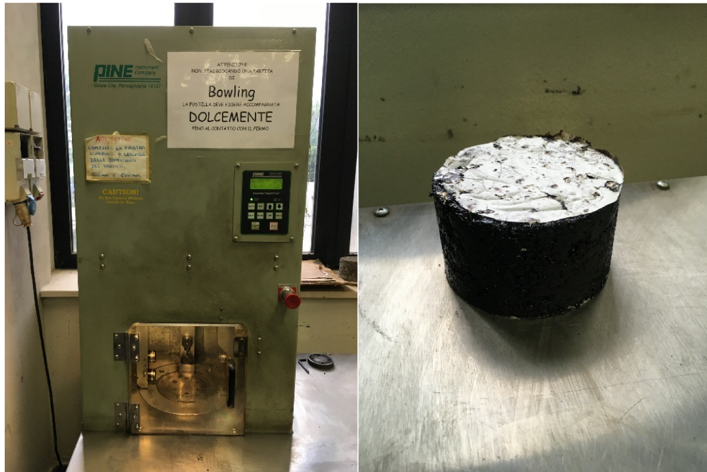
Figura 2.33: Pressa a taglio giratoria, fustella con d=100 mm, provino compattato
