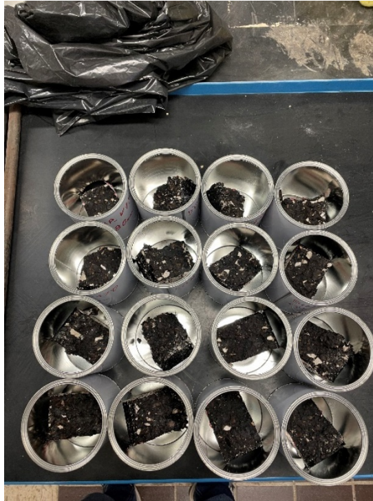
Figura 2.55: Parte del provino alla quale viene eseguita l'estrazione del bitume
