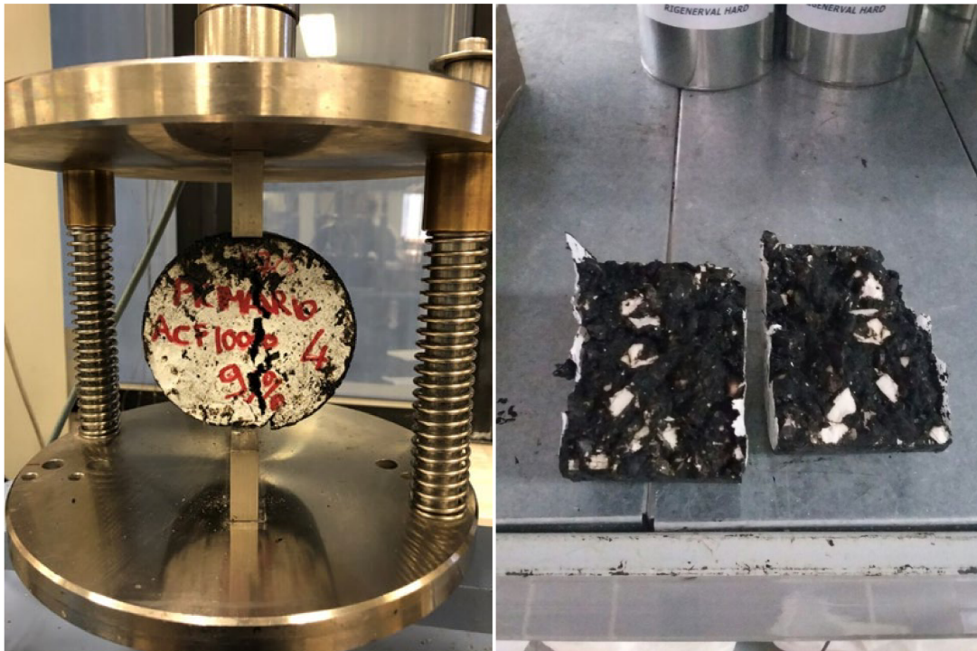
Figura 2.54: Provino rotto a seguito della prova a trazione indiretta
