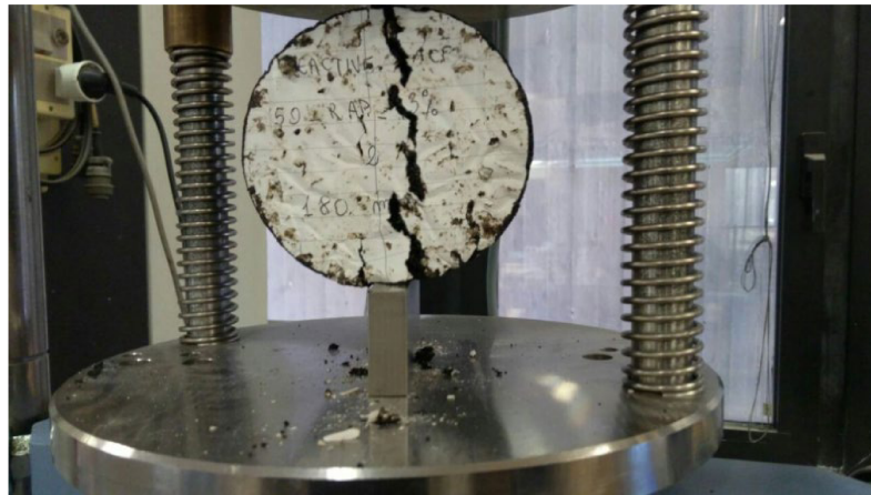
Figura 2.51: Provino rotto dopo la prova
