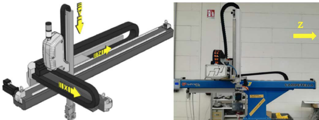
Figura 3.3 CAD (a sinistra) e foto (a destra) del robot cartesiano
