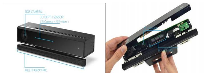
Figura 2. Componenti kinect v2
