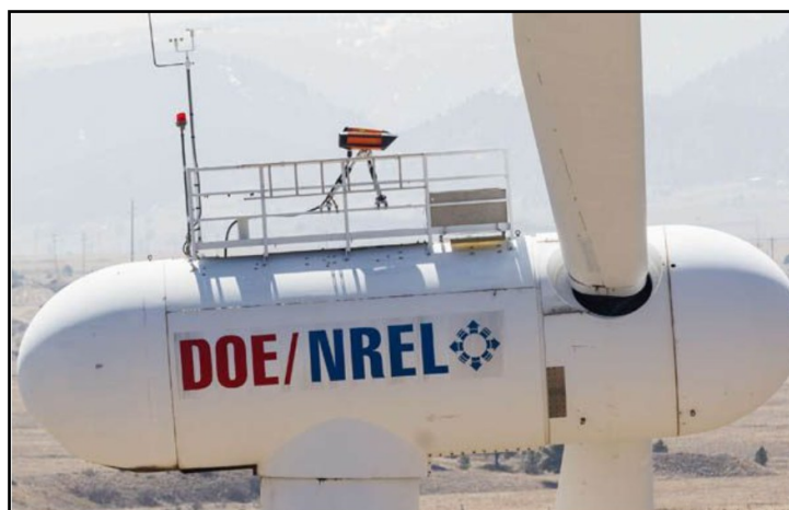
Figura 4.10 Lidar installato sulla navicella di una turbina eolica [29]
