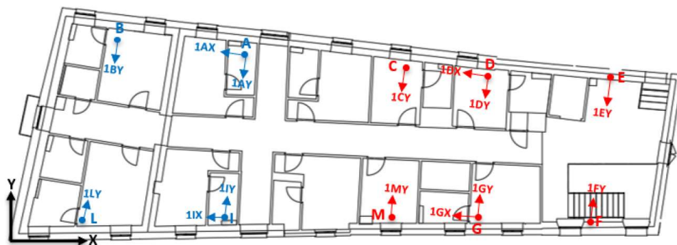
Figura 150: Disposizione accelerometri al piano primo dell'edificio
