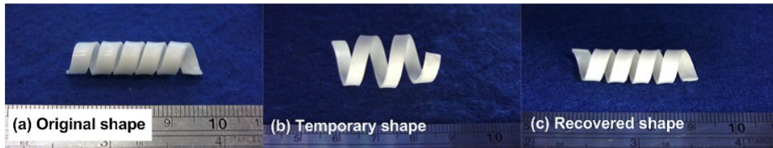
Figura 2: Esempio di un SMP dual-shape nella sua forma originale (a), deformata (b) e dopo che ha recuperato la deformazione (c).
