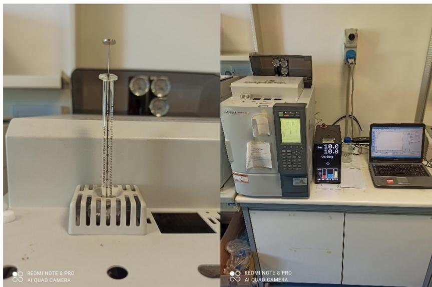
**Figura 10:** da sx dettaglio della siringa Hamilton usata per il prelievo e immagine del GC utilizzato per la determinazione dei volatili e alcoli superiori.
