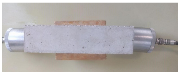
Figura 2.1. Esecuzione della tecnica in trasmissione diretta su un provino parallelepipedo
