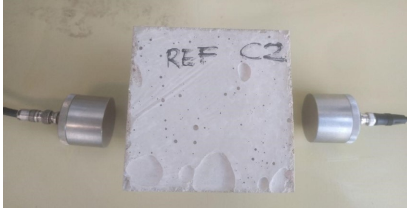
Figura 2.2 Esecuzione della tecnica in trasmissione diretta su un provino cubico
