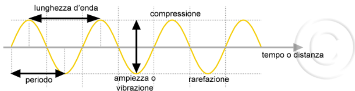
Figura 1.3. Caratteristiche fondamentali delle onde ultrasonore
