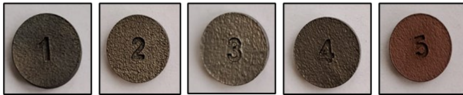
Figura 1. Dischetti di titanio sinterizzato sottoposti a diversi trattamenti di superficie.
