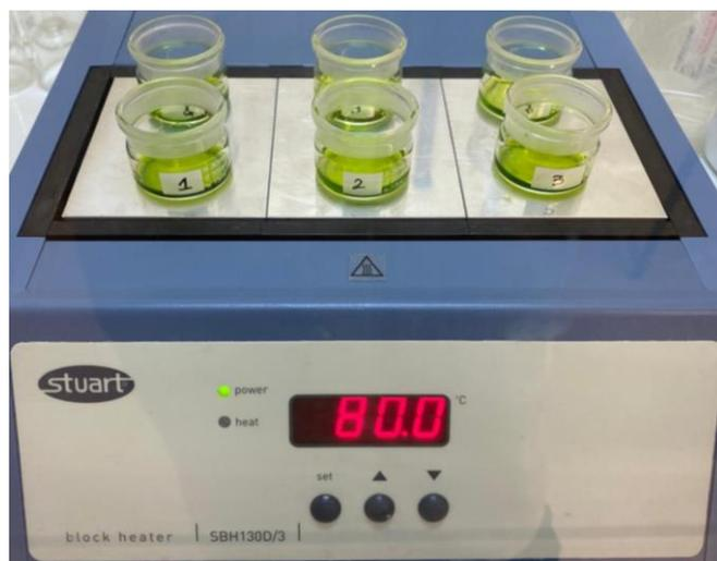
**Figura 16.** Piastra riscaldante (Stuart Block Heater SBH130D/3, Stuart, Stone, Regno Unito).
