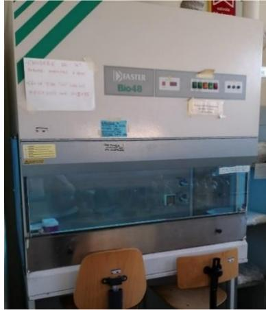
**Figura 5.** Cappa biologica a flusso laminare (Faster Bio 48, Faster S.r.l., Milano, Italia).
