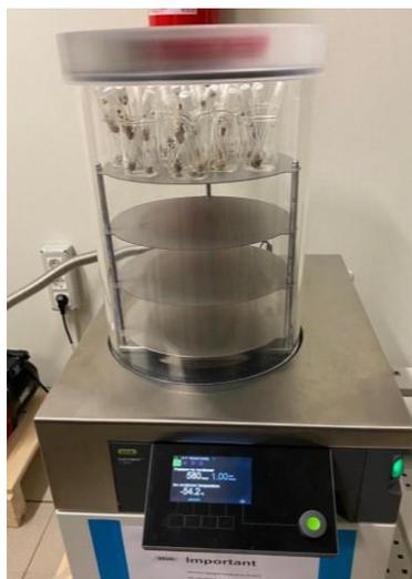
**Figura 13.** Liofilizzatore (BUCHI Lyovapor L-200).
