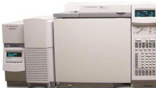
**Figura 19.** Gas Cromatografo Agilent 6890N accoppiato ad uno spettrometro di massa Agilent MSD 5973.
