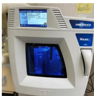
**Figura 18.** Microonde utilizzato per la tecnica MAE.
