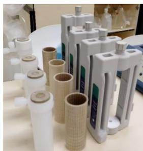
**Figura 17.** Contenitori in teflon PFA utilizzati per l'estrazione MAE.
