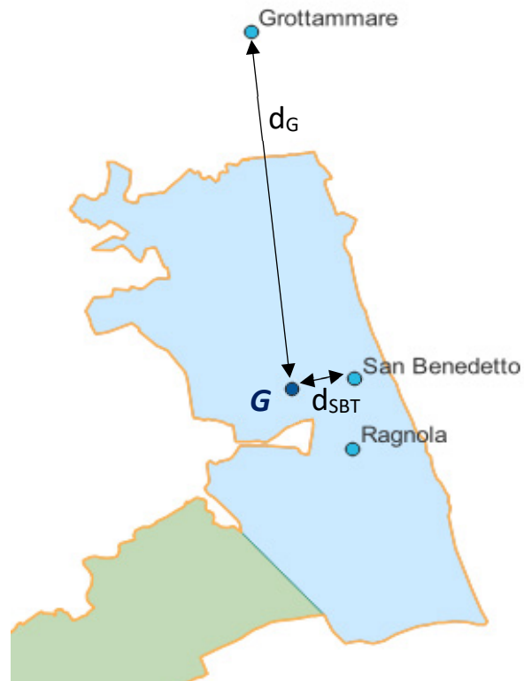
Figura 25 - Posizione delle stazioni pluviometriche rispetto al baricentro del bacino
