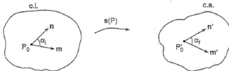
Figura 4: configurazione iniziale e deformata del corpo
