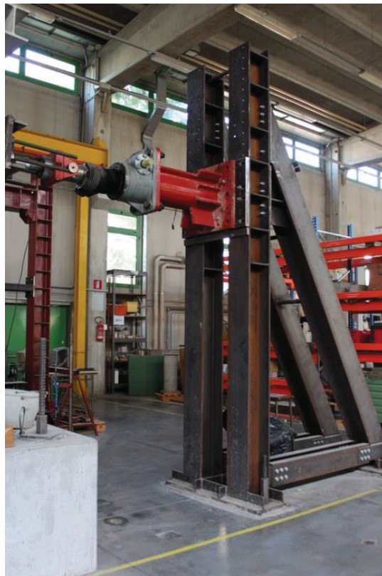
Figura 3: Struttura di contrasto laboratorio dell'Università degli Studi di Bologna
