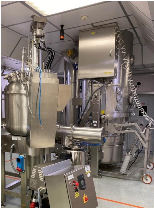
Figure 26: A sinistra la torre Glatt con vicino il granulatore. A destra una rappresentazione della tecnologia a letto fluidizzato
