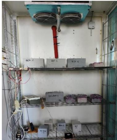
*Figura 7.5. Provini nella camera di carbonatazione*
