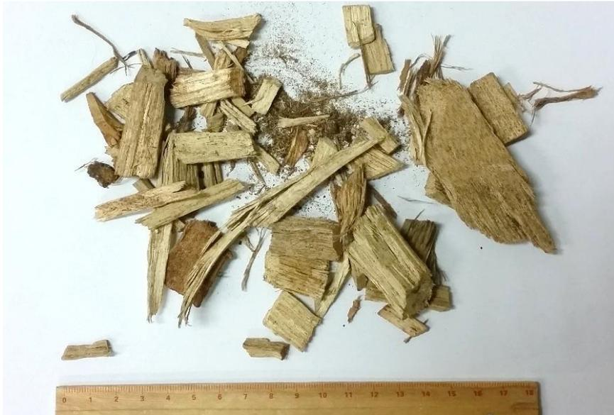
*Figura 2.3: Trucioli di legno destinati alla gassificazione*
