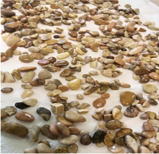
Figura 3.15. Misura ssa Ripanti River Gravel 10/15
