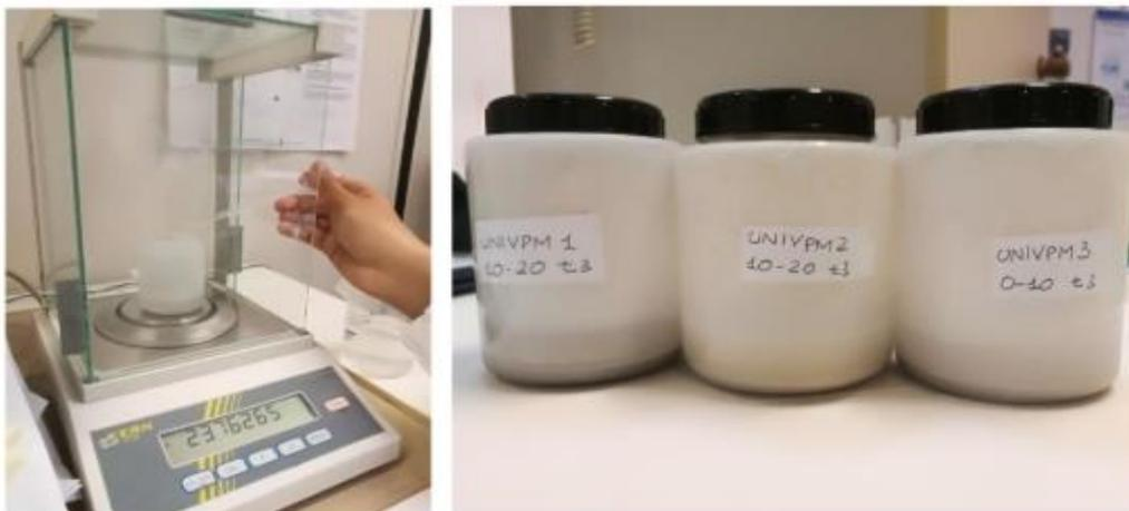
*Figura 7.9. Pesatura campioni e sistemazione nei contenitori a tenuta stagna*
