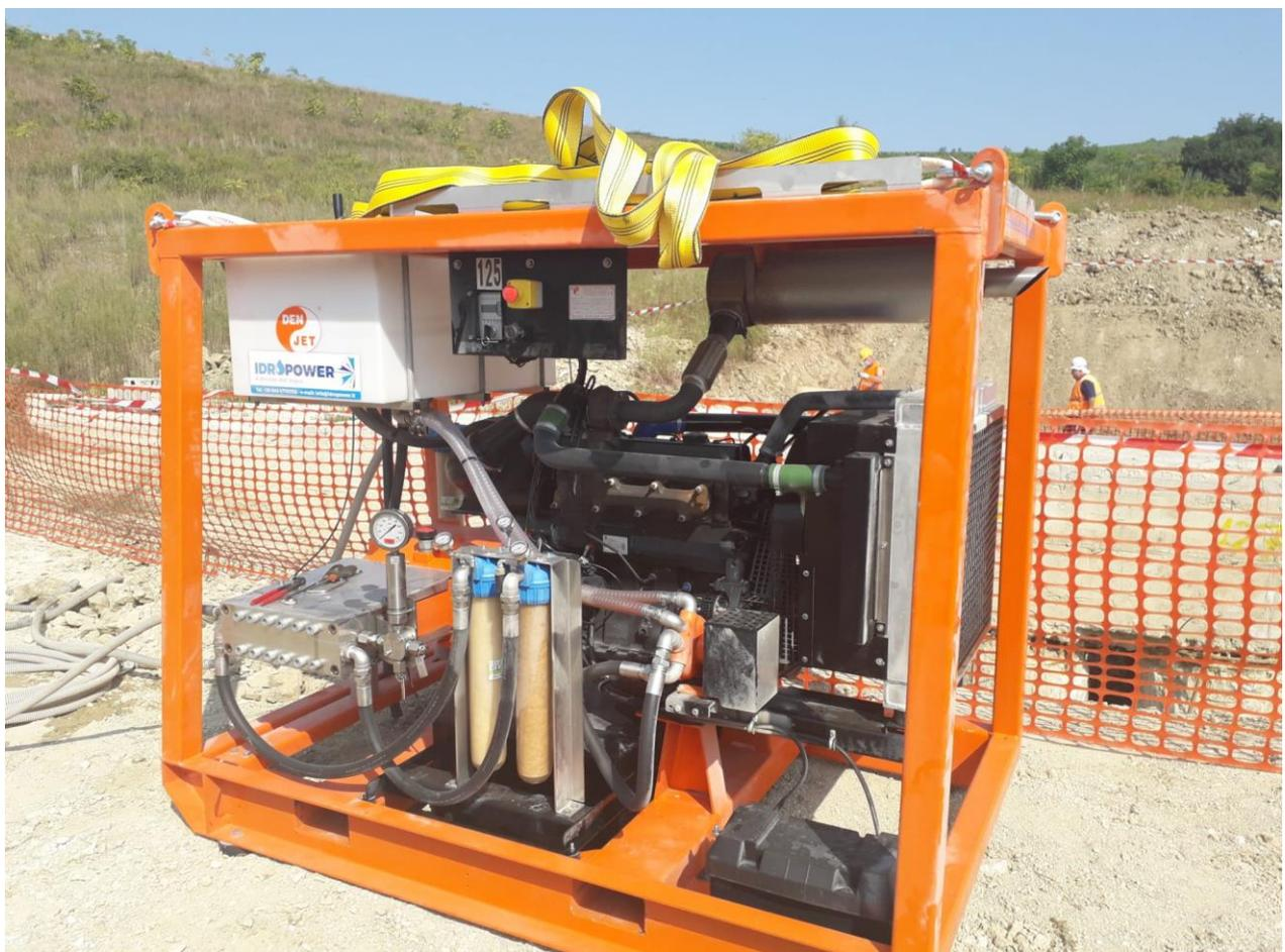
*Figura 4.14: Idrodemolitrice*
