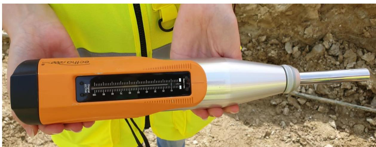
**Figura 4.9: Sclerometro meccanico di tipo N per calcestruzzo "ECTHA 1000"**
