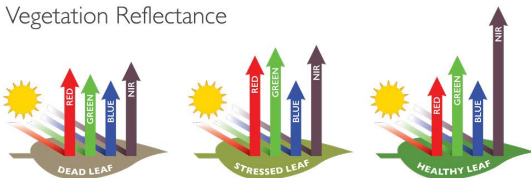
Figura 1-1: riflettanza della vegetazione in alcune bande in piante in diverso stato
