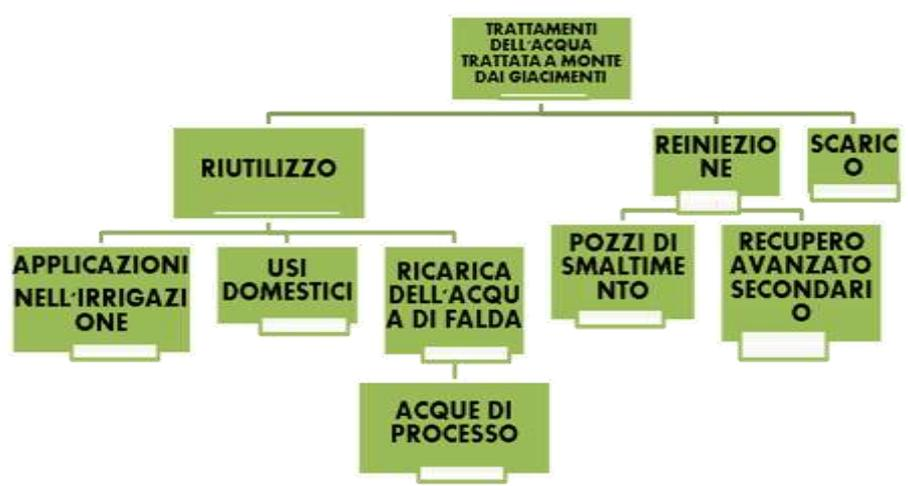
Schema illustrativo dei principali usi dell'acqua prodotta tramite le tecnologie a membrana.
