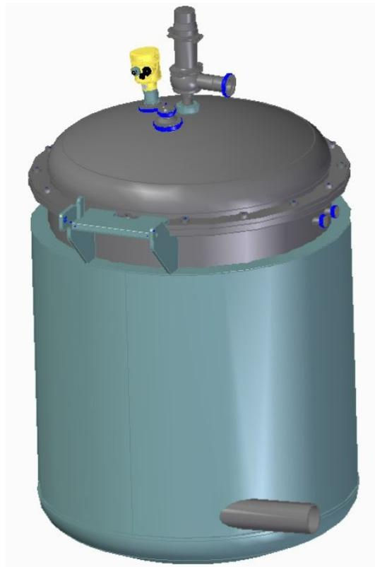
Figura 1.2: Serbatoio completo di: Camicia di coibentazione in verde, Bocchello di ingresso, Foro di uscita, Valvole di regolazione, Valvola di sicurezza, Spray-ball, Sonda
