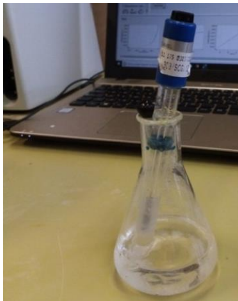
Fig. 3.3 - Elettrodo di riferimento al calomelano.
