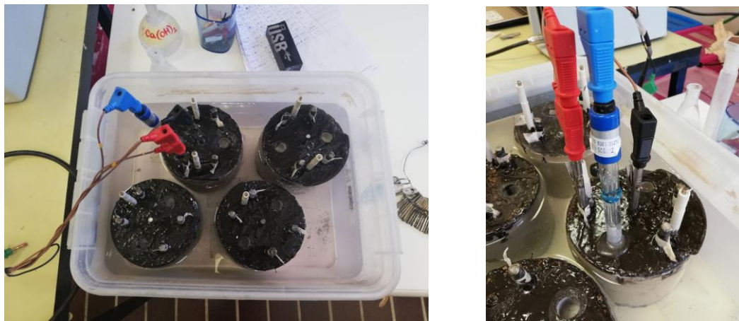
Fig. 6.6 - Esempio di prova di corrosione in bagnato.
