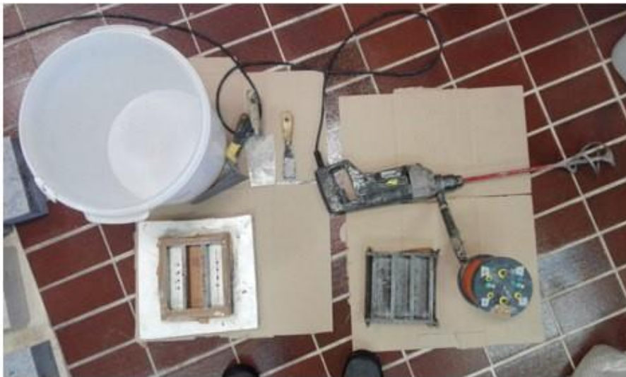
Fig. 3.7 - Attrezzatura utilizzata per la miscelazione.
