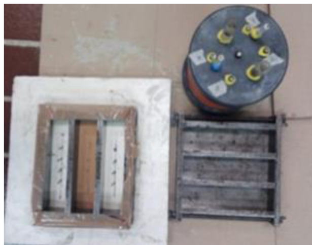
Fig. 3.9 - Casseforme utilizzate per il getto delle malte.
