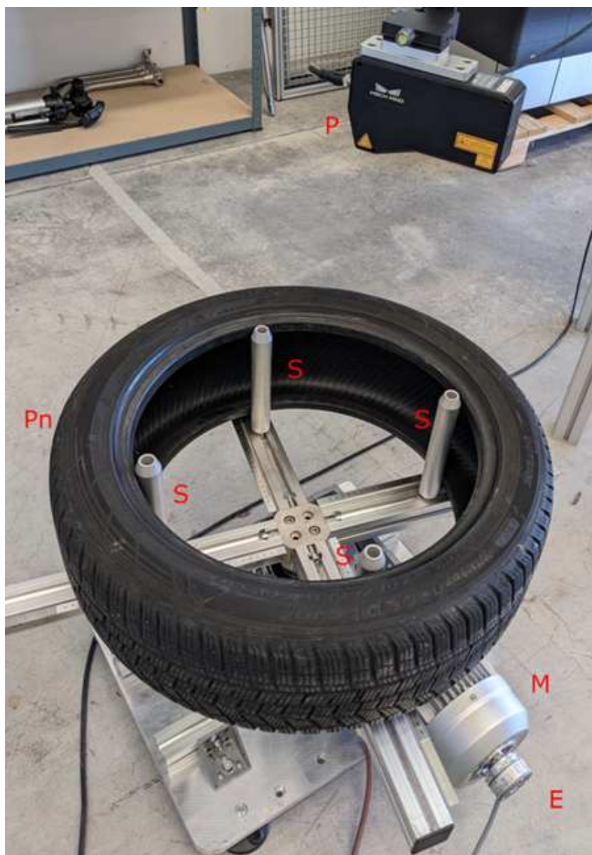
Figura 2.7: Foto del sistema di acquisizione e movimentazione
