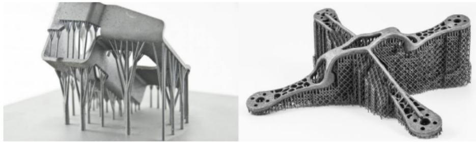
Figura 1.7: Supporti generati su componenti metallici mediante Software Materialise Magic[5]
