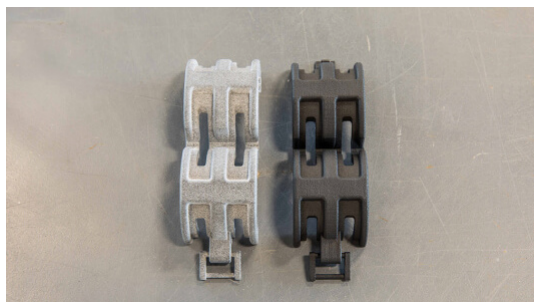
Figura 2.15: Pezzi in nylon fabbricati con tecnologia Multi Jet Fusion prima e dopo aver ricevuto la finitura a vernice nera[19]
