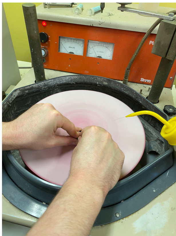
Figura 4.4: Smerigliatrice-lucidatrice in azione
