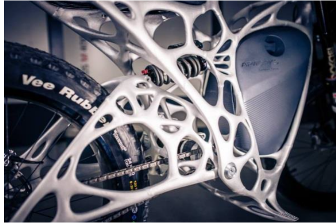
Figura 3.9: Telaio moto elettrica stampato in 3D con Scalmalloy[24]
