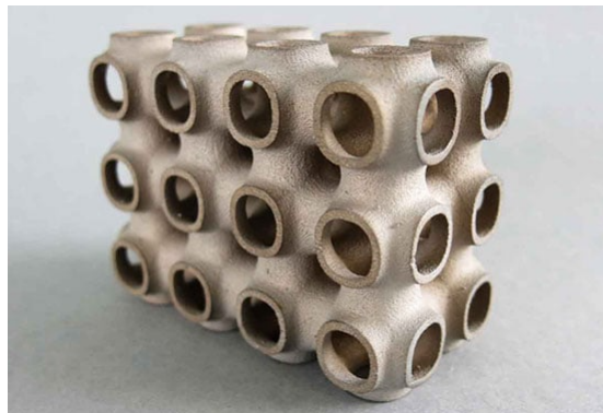
Figura 2.2: Pezzo di metallo stampato tramite tecnologia Binder jetting[9]
