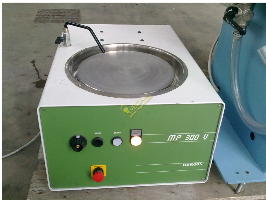
Figura 4.2: Lappatrice per la levigatura dei provini
