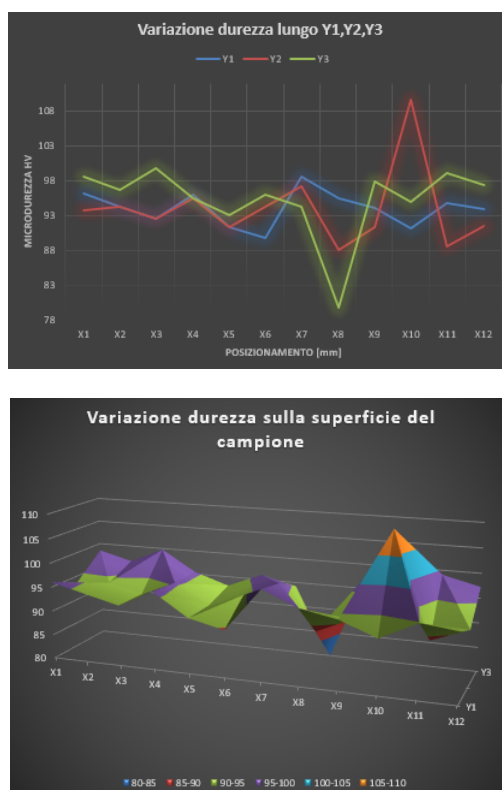
Figura 5.16: Variazione microdurezza del campione 18 XY Streght-Al lungo l'asse Y e sulla superficie
