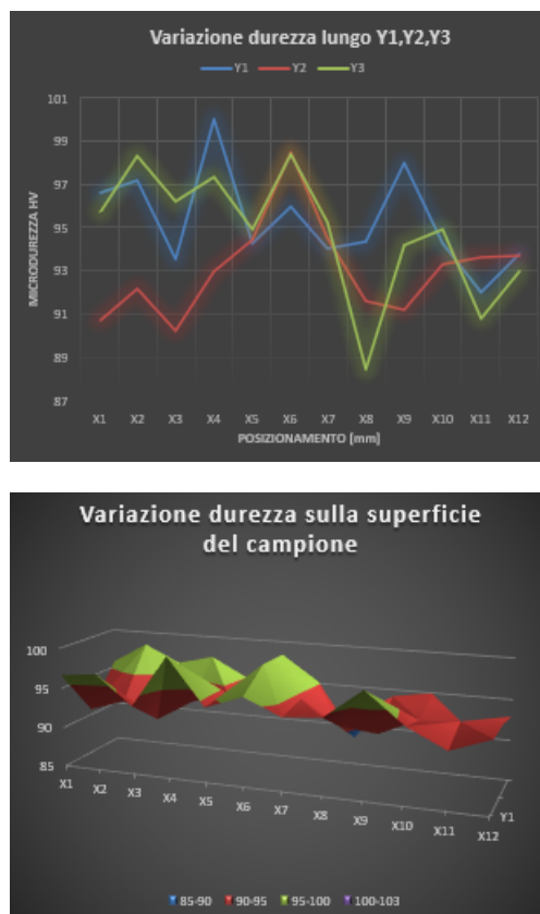
Figura 5.7: Variazione microdurezza del campione 7 XY Strenight-Al lungo l'asse Y e sulla superficie
