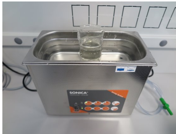
Figura 4.1: Operazione di pulitura tramite ultrasuoni
