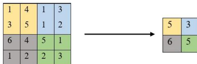
Figura 3.3.: Esempio di applicazione del Max Pooling con stride 2 e filtro di dimensione 2x2 tratto da [1]
