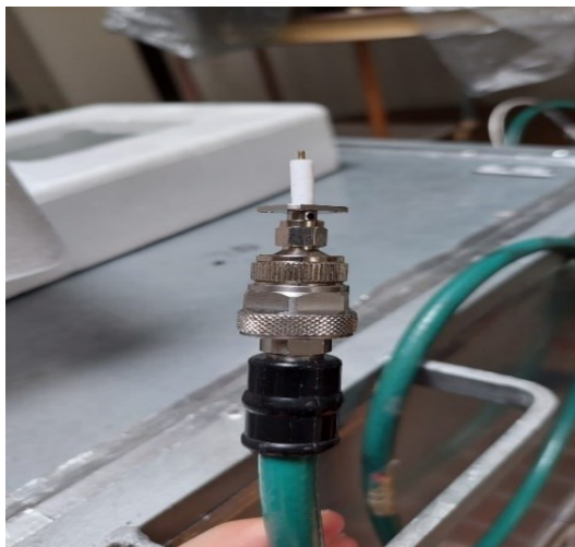
Figura 2.2 antenna a monopolo
