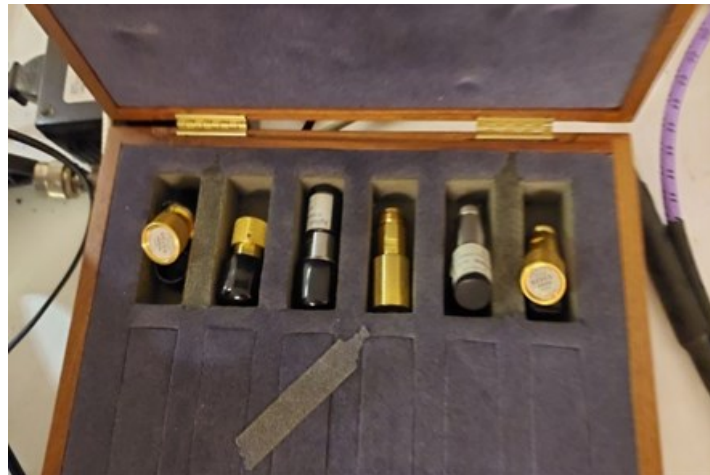
Figura 2.6 kit: un carico da 50 \Omega , un aperto e un corto circuito di tipo N maschio e femmina
