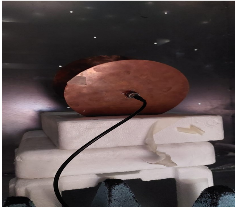
Figura 3.5 antenna in posizione 30 utilizzando piattaforme in polistirolo
