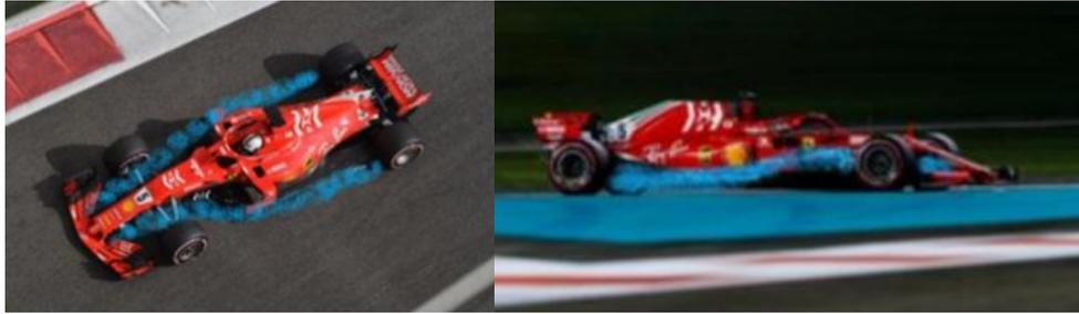
Figura 5.22 visualizzazione degli Y250 in una vettura Formula 1 in movimento
