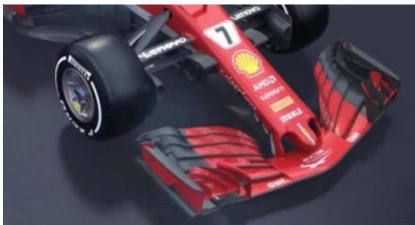
Figura 5.21 visualizzazione di un'ala anteriore di una vettura Formula 1 con dettaglio della parte centrale con profilo biconvesso simmetrico e i montanti, situati a 250 mm dall'asse centrale
