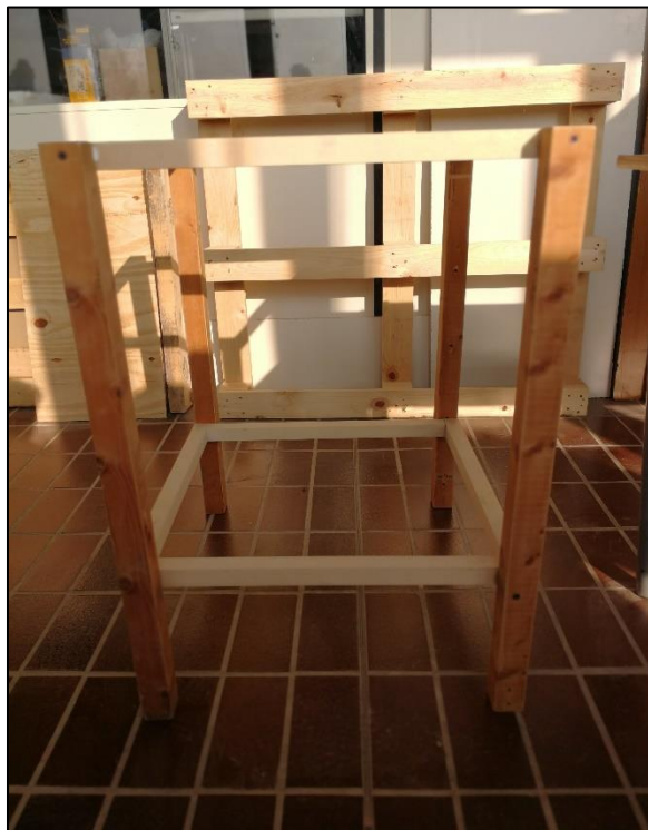
Figura 3-8: Assemblaggio Componenti Essiccatore Solare (2)
