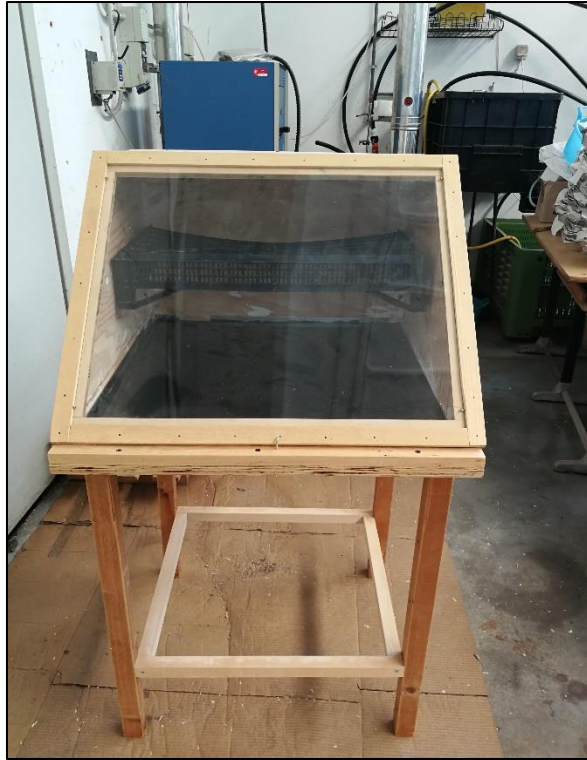
Figura 3-9: Essiccatore Solare assemblato (1)
