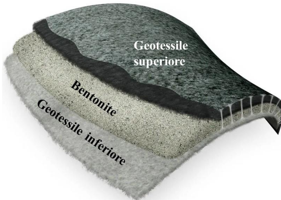
Figura 1: Schema GCL con geotessili (fonte: https://www.archiexpo.it/prod/cetco-europe/product-60195-427882.html ).
