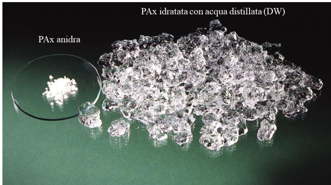
Figura 21: Differenza tra poliacrilammide reticolare (Pax) anidra ed idratata con acqua distillata (DW) con conseguente formazione di idrogel.
