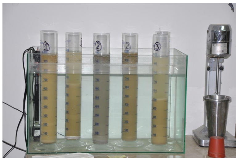
Figura 33: Vasca termostatica (a sinistra) ed agitatore (a destra). (Fonte: http://www.geo3.biz/laboratorio/ )
