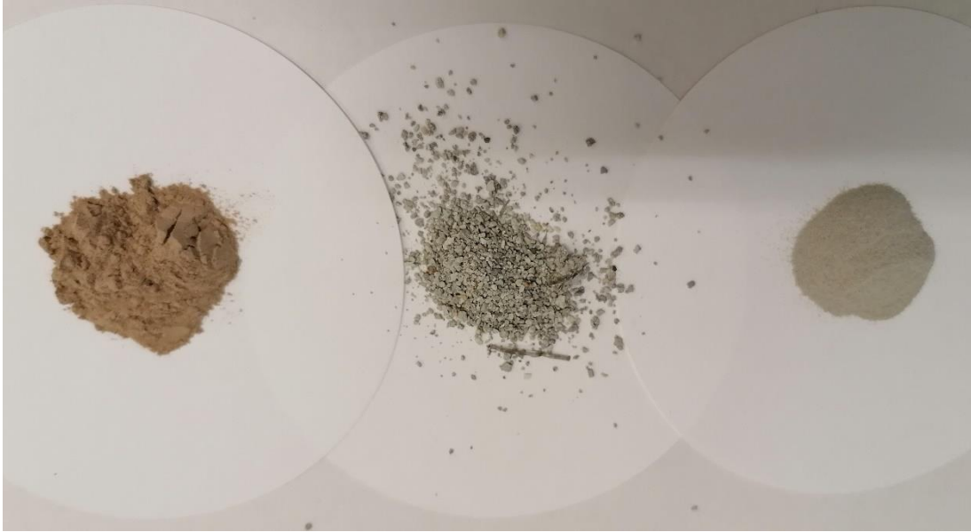
Figura 13: Confronto tra le due bentoniti utilizzate, in ordine da sinistra a destra: GCL1 passante al setaccio n.80 (180 \mu\text{m} ); GCL2 granulata e quindi non passante al setaccio n.80 (180 \mu\text{m} ); GCL2 sminuzzata con il mortaio e quindi passante al setaccio n.80 (180 \mu\text{m} ).
