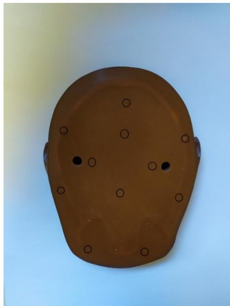
*Figura 10: Esempio di sezione assiale del fantoccio antropomorfo con fori cilindrici per l'inserimento dei TLD Rods.*
