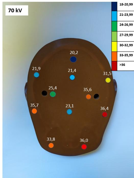
Figura 28: Sezione del fantoccio Alderson Rando con relative dosi (in mGy) a 70 kVp.
