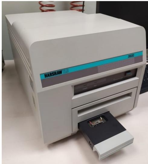
*Figura 12: Lettore manuale Harshaw 3500 con alloggiamento metallico per TLD.*
