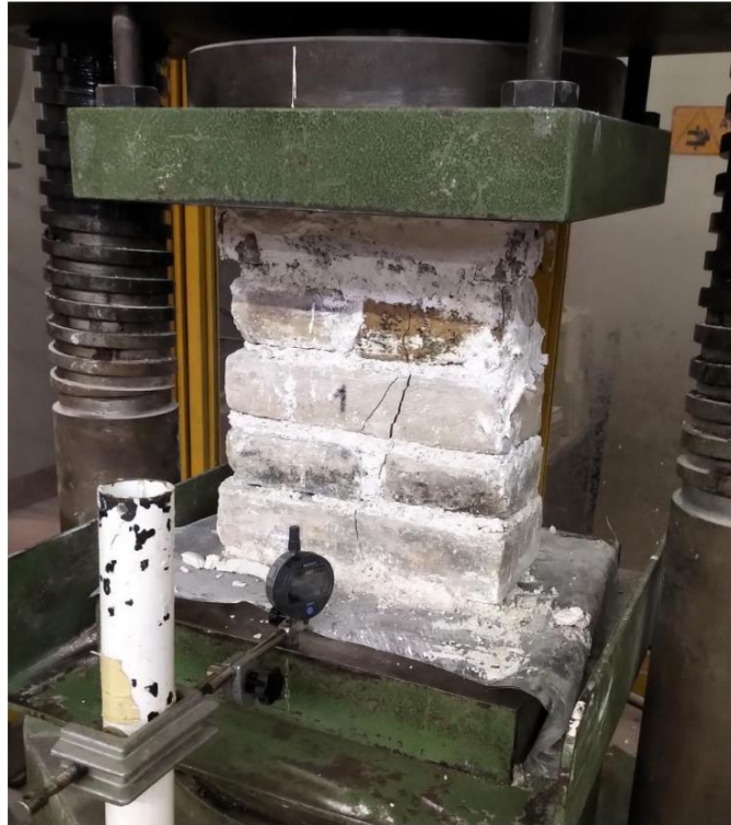
Fig. 5.4.1.3.III – set-up per prova di compressione su campione n.1 e fessurazione
