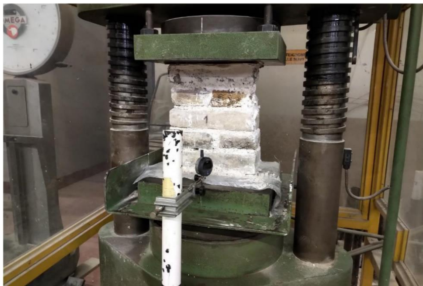
Fig. 5.4.1.3.II – set-up per prova di compressione su campione n.1.
