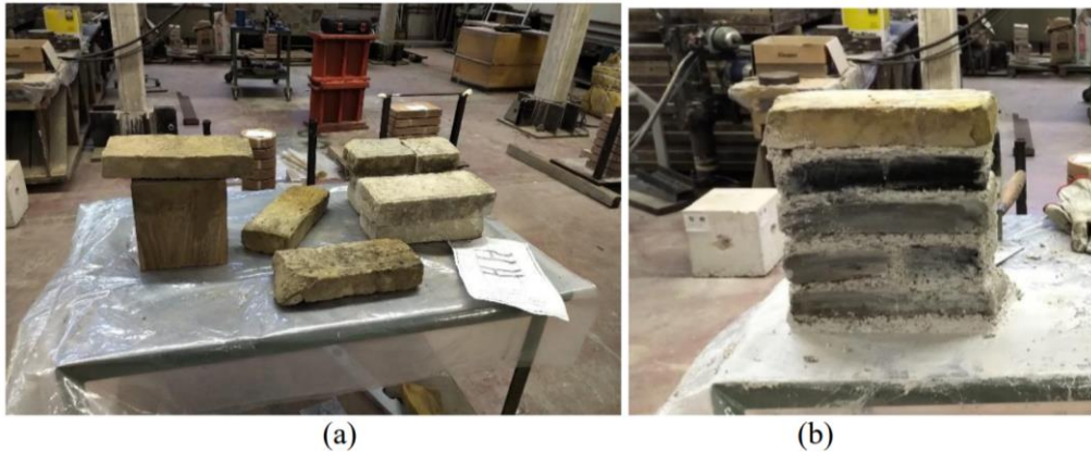
Fig. 5.4.1.3.I – (a) mattoni storici prelevati e (b) campione di prova a compressione.
