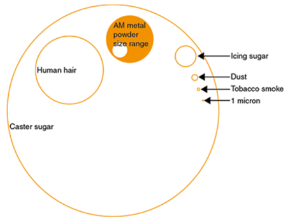
Fig 2.1 Confronto tra le dimensioni delle particelle metalliche per PBF e quelle tipiche di altri oggetti.
