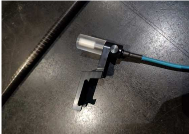
Figura 25- Applicatore TruFix alla camera Semiflex 3D
