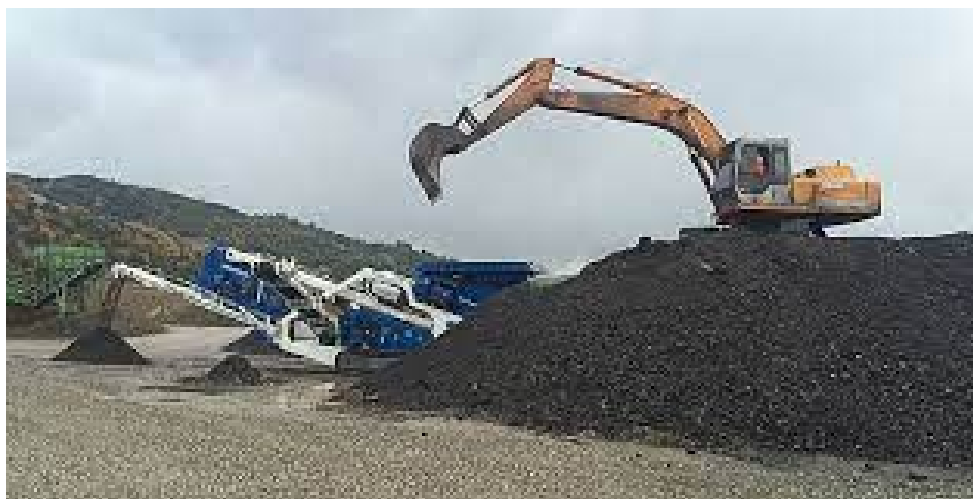
Figura 3.6 - Produzione di conglomerato a freddo
