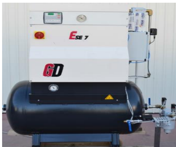
Figura 4.1 compressore a doppia vite ad iniezione ad olio GD ESE 7
