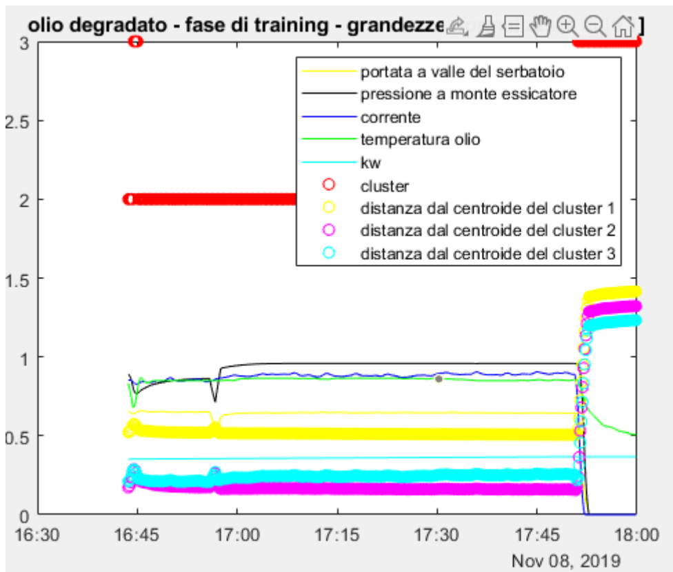
Figura 6.9 dati fase di training con olio degradato
